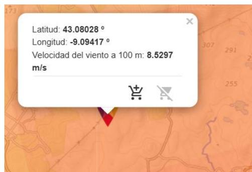
Figura 85. Velocidad promedio del viento a 100 metros de altura en el Emplazamiento 2 [31].
