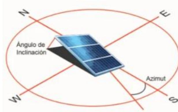
Figura 4. Ángulos característicos del panel solar. Fuente: sfe-solar
