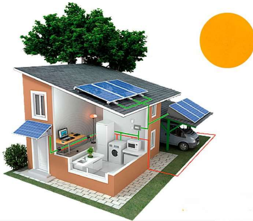
Ilustración 13: Instalación fotovoltaica aislada de la red.
