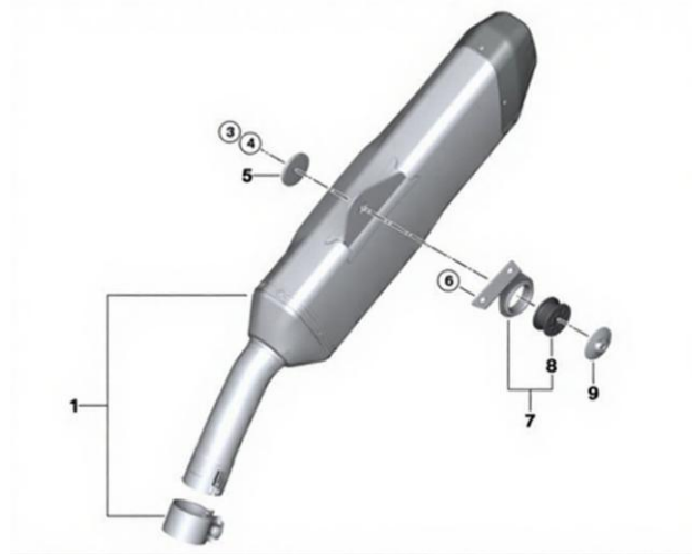
Ilustración 13: Despiece del silenciador de la BMW
