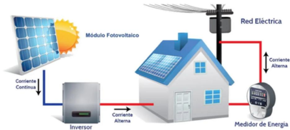
Figura 2: Sistema fotovoltaico conectado a la red [Ilum23]
