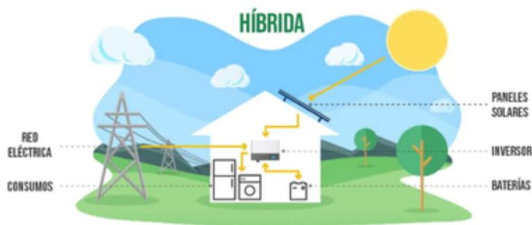
Figura 4: Sistema fotovoltaico híbrido [Auto25a]
