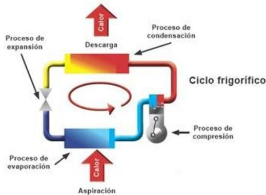
Figura 9. Ciclo de funcionamiento de una bomba de calor aerotérmica
