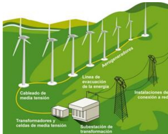
Ilustración 10. Obtención de la energía eléctrica desde el viento.
