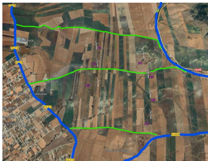
Ilustración 26. Caminos de acceso al parque eólico. Fuente: Elaboración propia.
