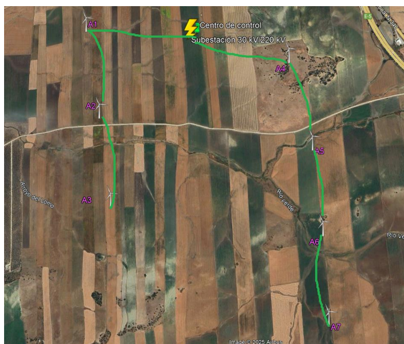
Ilustración 28. Zanjas del parque eólico. Fuente: Elaboración propia.
