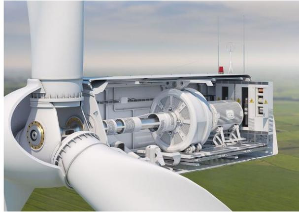
*Figura 24: Góndola de un aerogenerador [51].*
