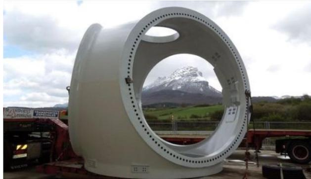
*Figura 22: Buje de un aerogenerador [49].*
