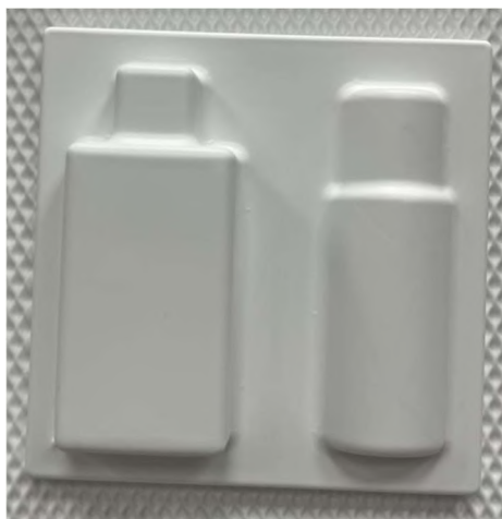
Ilustración 117: Ensayo termoformado - molde macho mecanizado - PS 1.00 mm (Elaboración propia)
