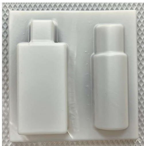
Ilustración 104: Ensayos del modelo macho con sistema de varillas de guiado – PS 0.5 mm (Elaboración propia)
