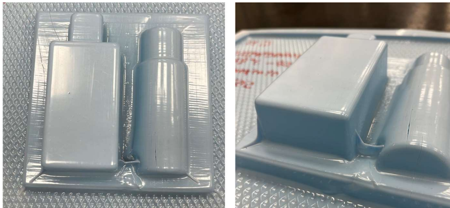
Ilustración 37: Ensayo macho con vacío - PETG 0.5mm (Elaboración propia)
