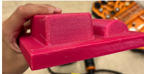
Ilustración 15: Resultado tras lijar la pieza (Elaboración propia)
