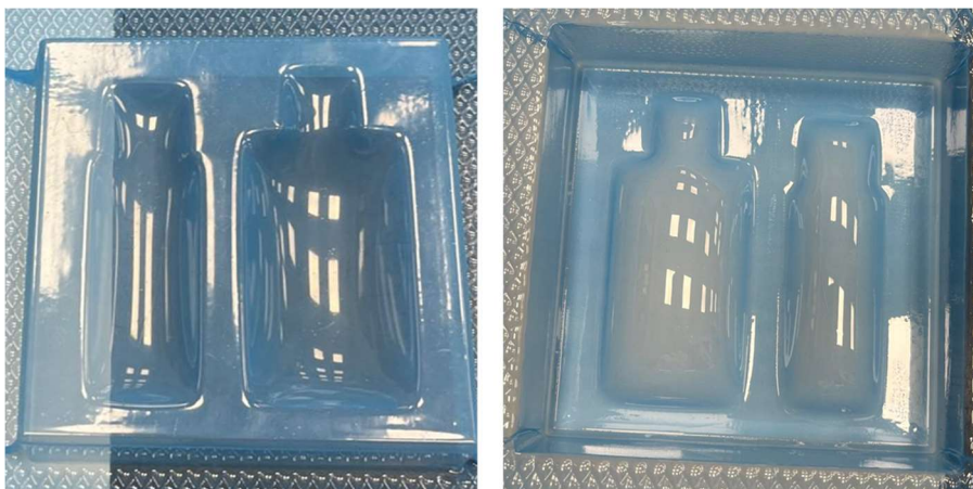
Ilustración 44: Ensayo hembra sin vacío- Rigid 10K - PETG 0.5mm (Elaboración propia)
