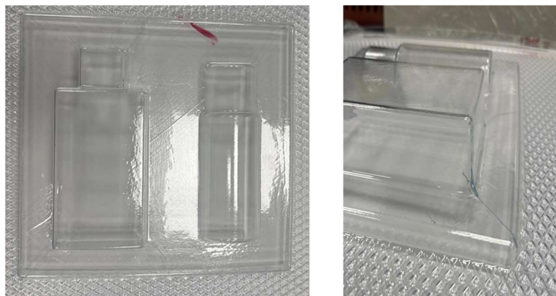
Ilustración 66: Prueba inicial molde macho V2 - PS 1mm (transparente) (Elaboración propia)
