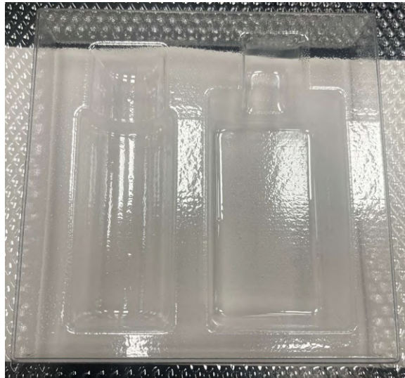
Ilustración 54: Ensayo hembra con vacío (1mm) - PA12 - PETG 0.5mm (I) (Elaboración propia)
