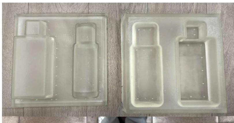
Ilustración 81: Moldes finales fabricados con impresión 3D (Elaboración propia)
