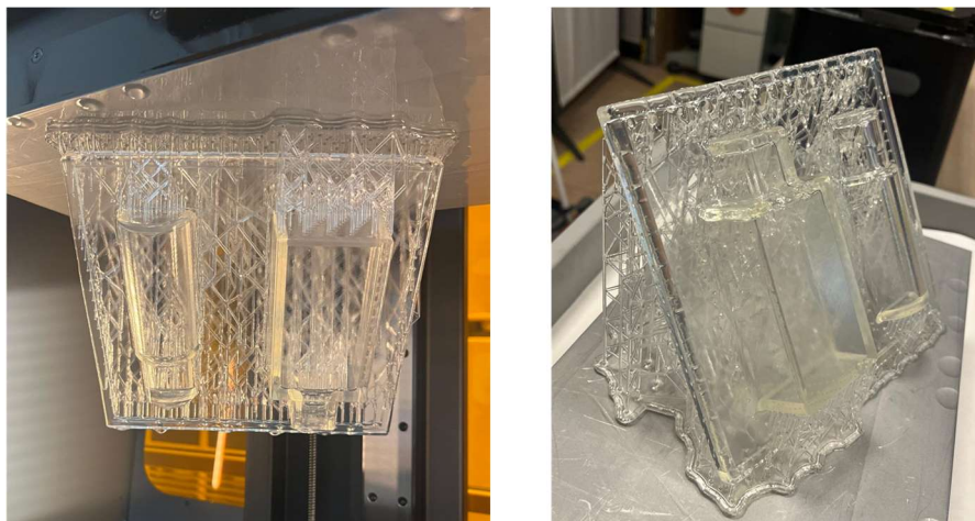
Ilustración 62: Resultado de la impresión del molde V2 (Elaboración propia)
