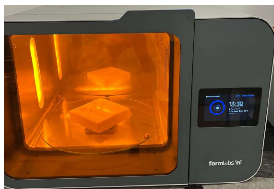
Ilustración 22: Curado UV molde prueba Rigid 10K (Elaboración propia)
