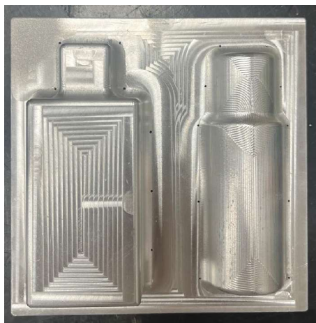
Ilustración 93: Molde macho en Aluminio (Elaboración propia)
