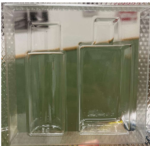
Ilustración 50: Ensayo hembra con vacío (1mm) - Clear V4 - PETG 0.5mm (Elaboración propia)
