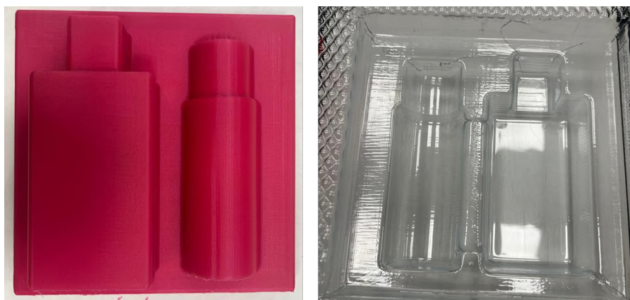
Ilustración 7: Molde fabricado por FDM (izquierda) y blíster obtenido mediante termoformado (derecha) (Elaboración propia)
