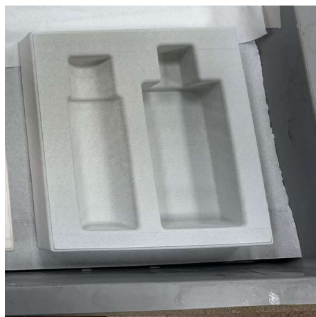
Ilustración 26: Resultado post-procesado del molde hembra prueba en MJF (Elaboración propia)
