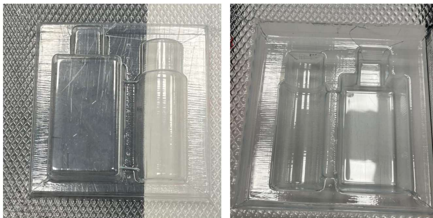
Ilustración 38: Ensayo macho con vacío - PS 1mm (Elaboración propia)
