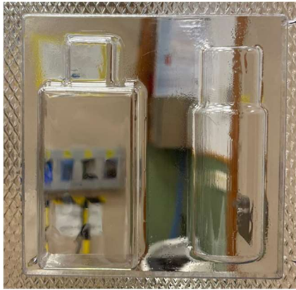
Ilustración 115: Ensayo termoformado - molde macho mecanizado - PETG 1.00 mm (Elaboración propia)
