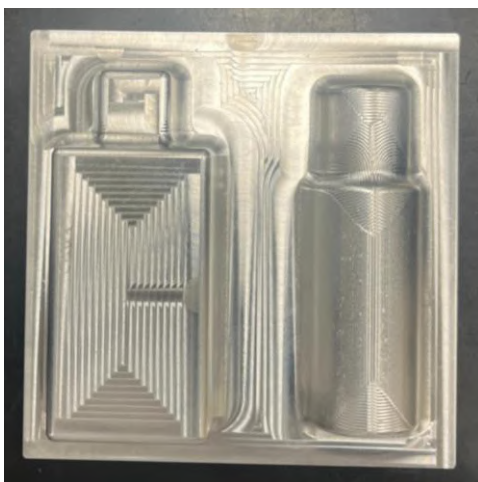
Ilustración 5: Molde macho en aluminio (Elaboración propia)
