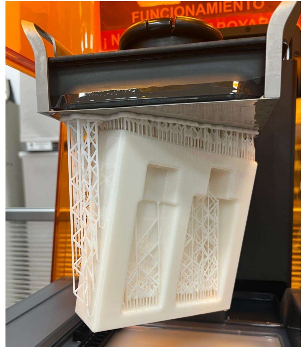
Ilustración 18: Resultado impresión molde hembra SLA Rigid 10K (Elaboración propia)
