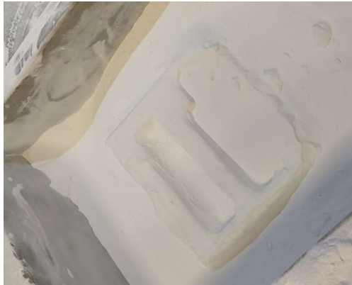
Ilustración 25: Molde hembra de prueba en el lecho de polvo (Elaboración propia)
