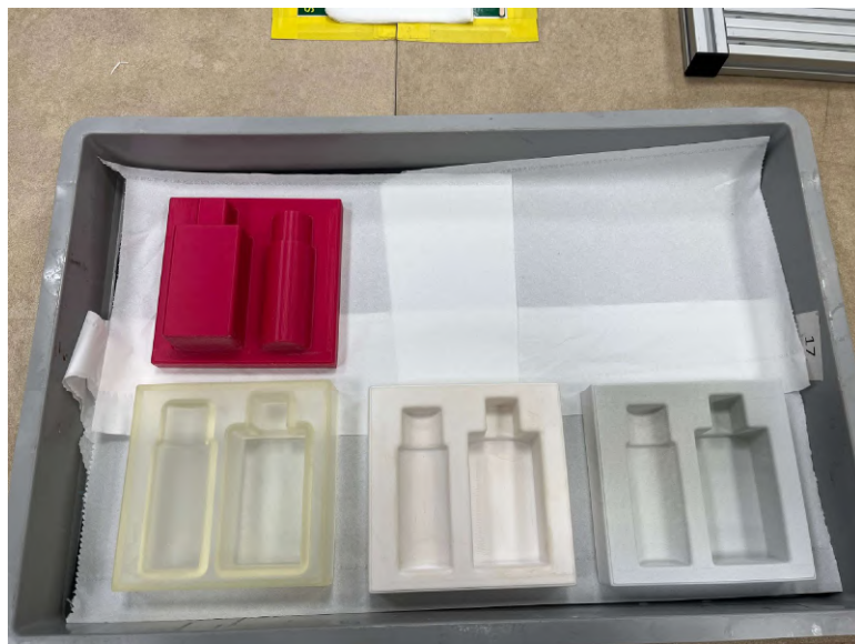
Ilustración 27: Moldes de prueba (Elaboración propia)
