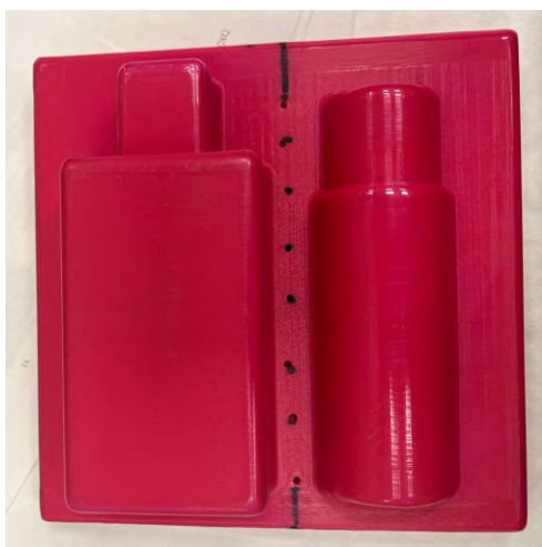
Ilustración 34: Agujeros de vacío del molde macho de prueba (Elaboración propia)
