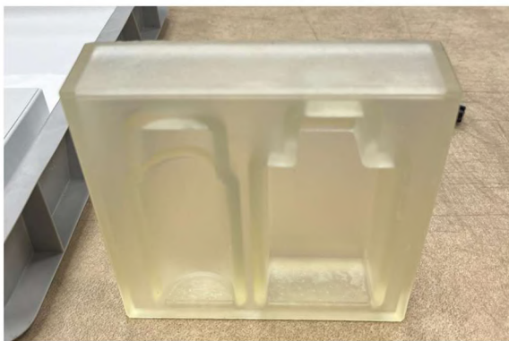
Ilustración 23: Puntos de Contacto de los Soportes SLA (Elaboración propia)
