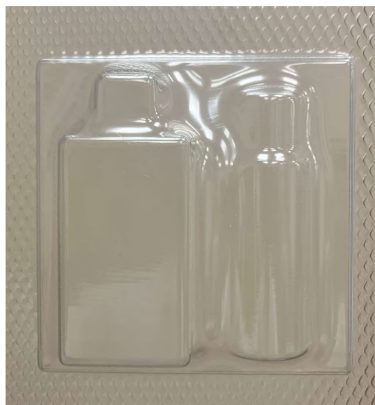
Ilustración 29: Ensayo macho sin vacío - PVC 1mm (Elaboración propia)
