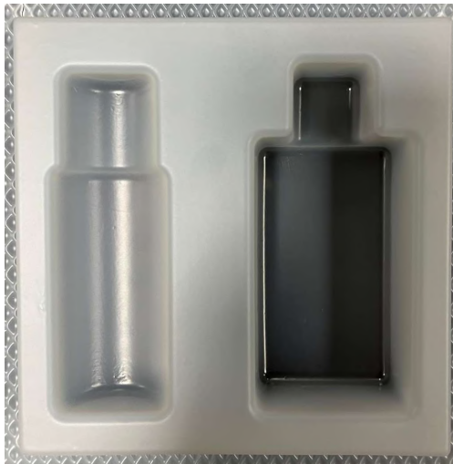
Ilustración 110: Ensayo termoformado - molde hembra impreso en 3D - PS 0.7 mm (Elaboración propia)
