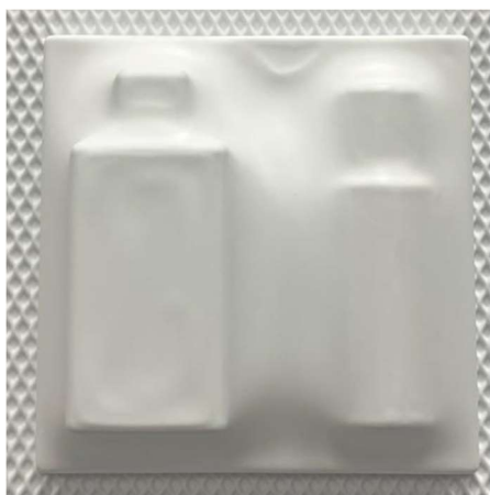
Ilustración 91: Prueba de termoformado del molde macho en Aluminio sin agujeros de vacío (Elaboración propia)
