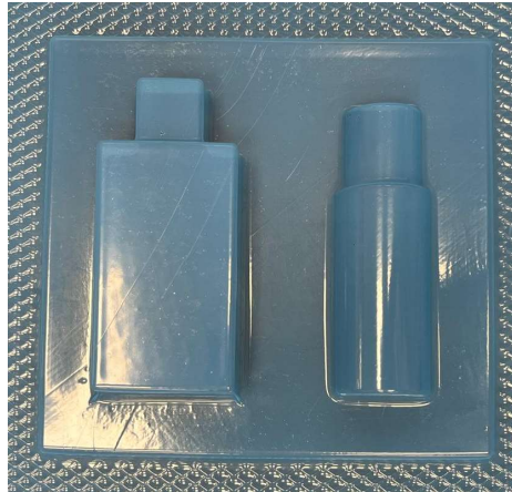
Ilustración 65: Prueba inicial molde macho V2 - PETG 0.5mm (Elaboración propia)
