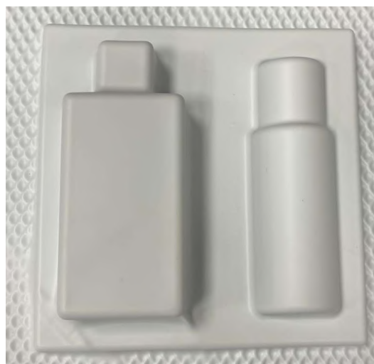
Ilustración 103: Ensayos del modelo macho con sistema de varillas de guiado – PETG 1.0 mm (Elaboración propia)
