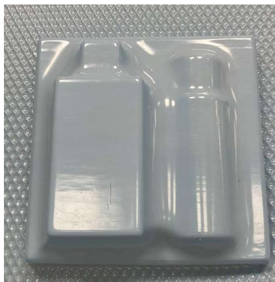
Ilustración 31: Ensayo macho sin vacío - PETG 0.5mm (Elaboración propia)
