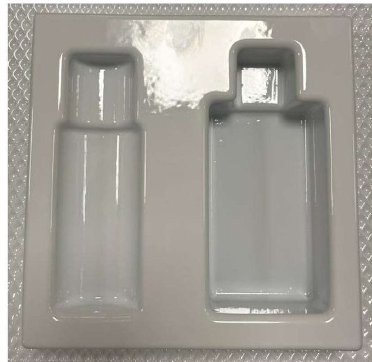
Ilustración 111: Ensayo termoformado - molde hembra impreso en 3D - PS 1.0 mm (Elaboración propia)
