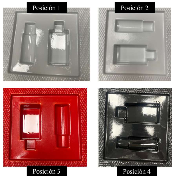
Ilustración 73: Resultado de los ensayos de cambio de orientación (Elaboración propia)
