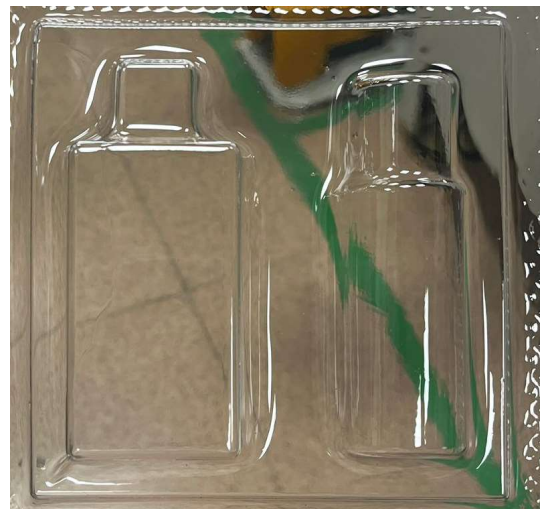
Ilustración 100: Ensayo termoformado - molde macho en 3D - PC 0.75 mm (Elaboración propia)
