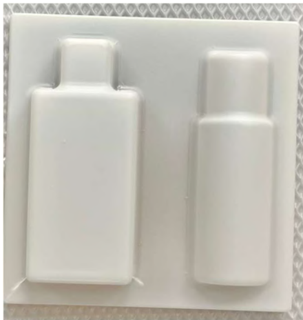
Ilustración 116: Ensayo termoformado - molde macho mecanizado - PS 0.50 mm (Elaboración propia)
