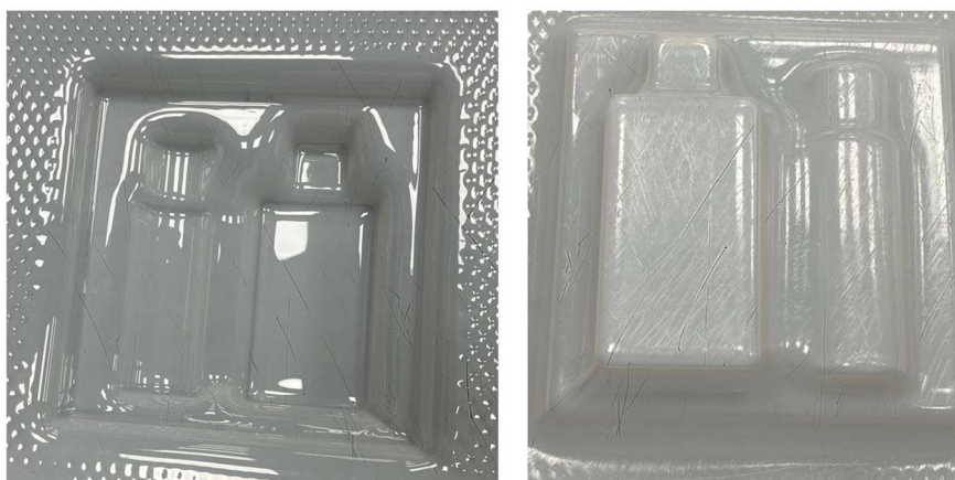
Ilustración 39: Ensayo macho con vacío - PC 0.7mm (Elaboración propia)
