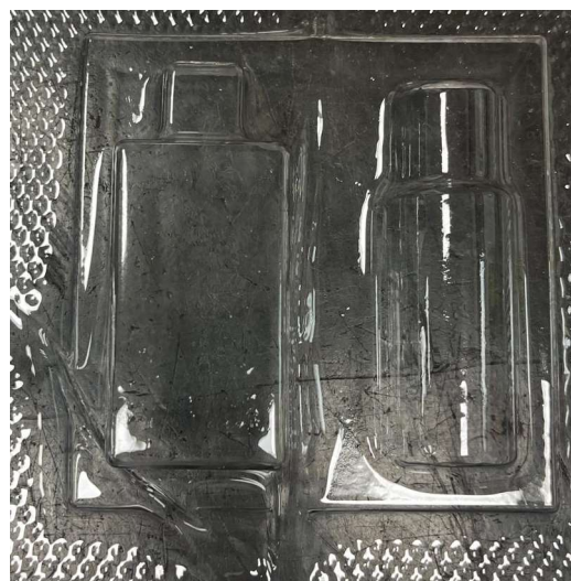
Ilustración 107: Ensayos del modelo macho con sistema de varillas de guiado – PC 0.75 mm (Elaboración propia)
