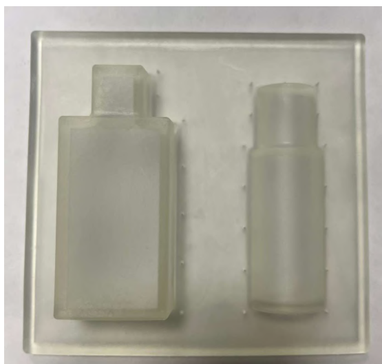
Ilustración 63: Resultado Post-procesado del Molde Macho V2 (Elaboración propia)
