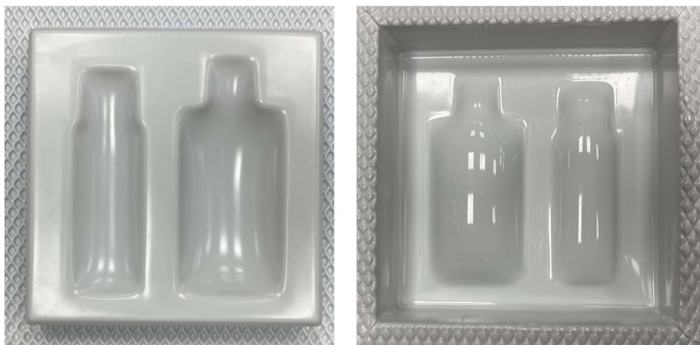
Ilustración 43: Ensayo hembra sin vacío- Rigid 10K - HIPS 1mm (Elaboración propia)
