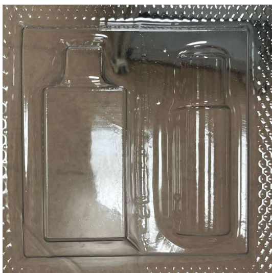
Ilustración 106: Ensayos del modelo macho con sistema de varillas de guiado – PVC 0.7 mm (Elaboración propia)
