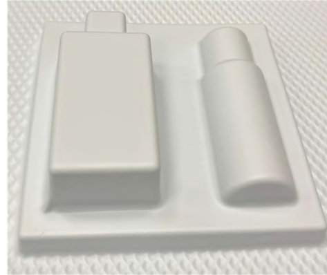
Ilustración 98: Ensayo termoformado - molde macho en 3D - PS 1.0 mm (Elaboración propia)
