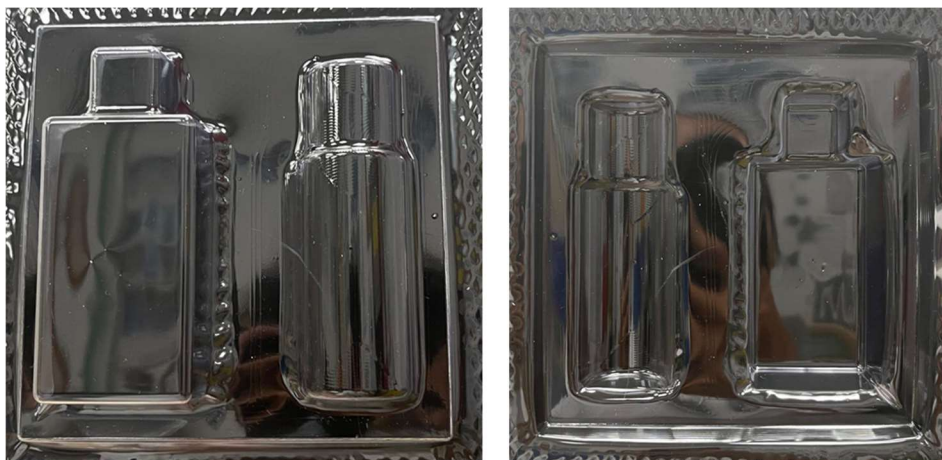
Ilustración 118: Ensayo termoformado - molde macho mecanizado - PVC 0.70 mm (Elaboración propia)
