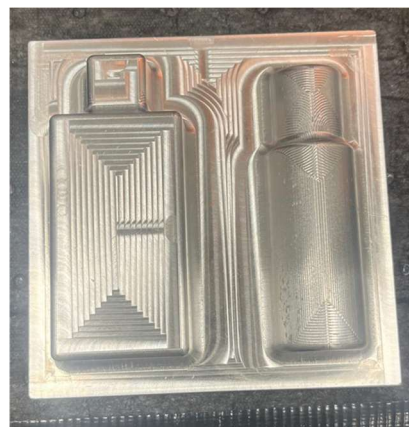
Ilustración 90: Resultado del mecanizado de la pieza macho (Elaboración propia)
