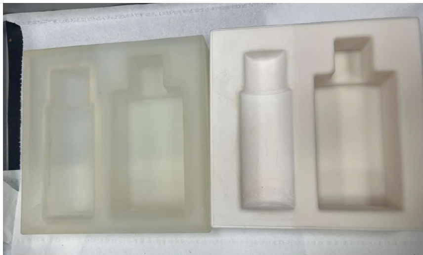
Ilustración 24: Granallado de los moldes de prueba SLA (Elaboración propia)
