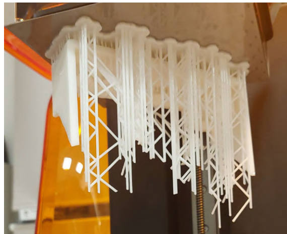
Ilustración 17: Fallo de impresión SLA (Elaboración propia)
