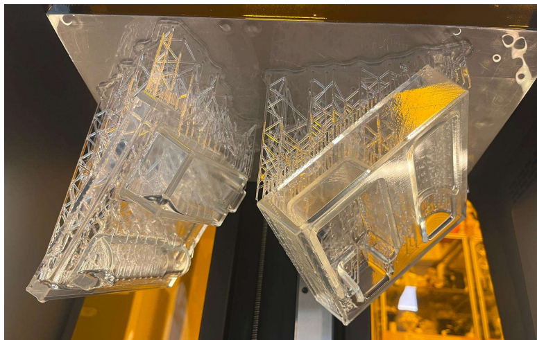
Ilustración 80: Resultado de la impresión de los moldes finales (Elaboración propia)
