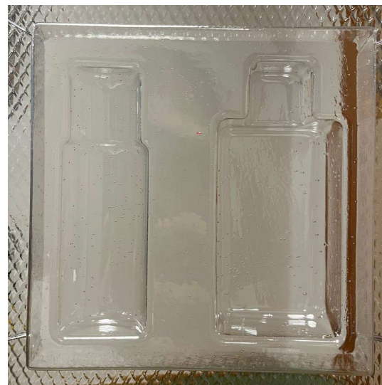
Ilustración 113: Ensayo termoformado - molde hembra impreso en 3D - PC 0.75 mm (Elaboración propia)
