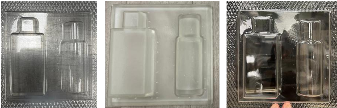
Ilustración 8: Molde fabricado por SLA (centro) y blíster obtenido mediante termoformado (laterales) (Elaboración propia)
