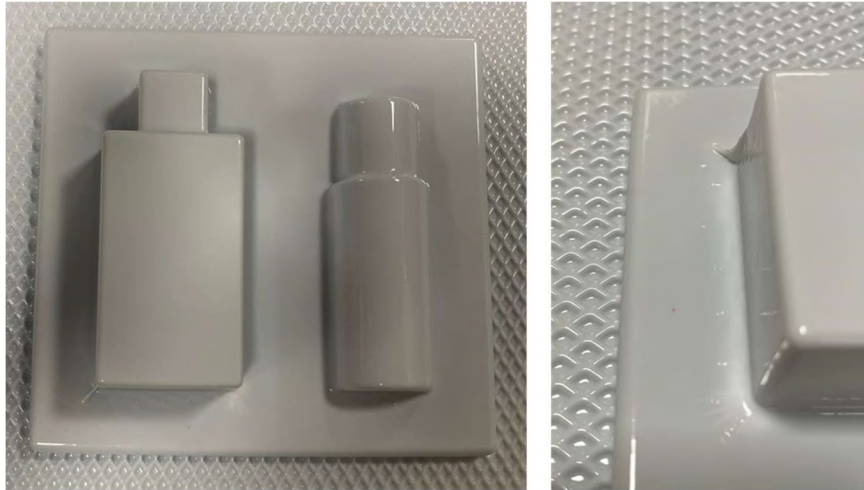
Ilustración 64: Prueba inicial molde macho V2 - HIPS 1mm (Elaboración propia)
