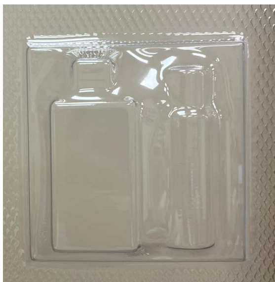
Ilustración 30: Ensayo macho sin vacío - PVC 0.7mm (Elaboración propia)
