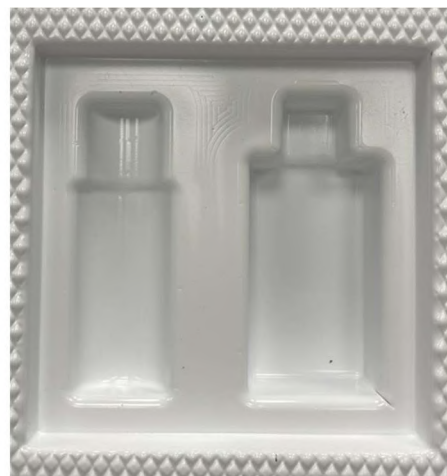
Ilustración 117: Ensayo termoformado - molde macho mecanizado - PS 1.00 mm (Elaboración propia)
