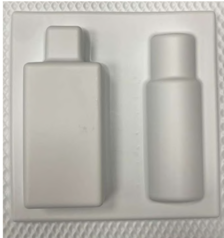
Ilustración 98: Ensayo termoformado - molde macho en 3D - PS 1.0 mm (Elaboración propia)
