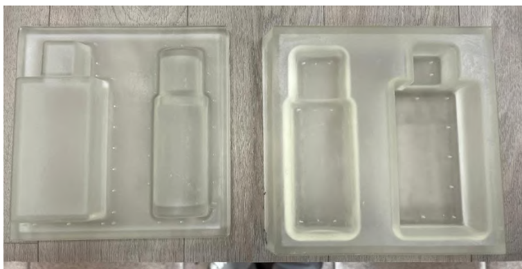
Ilustración 6: Molde macho (izquierda) y hembra (derecha) en SLA (Elaboración propia)
