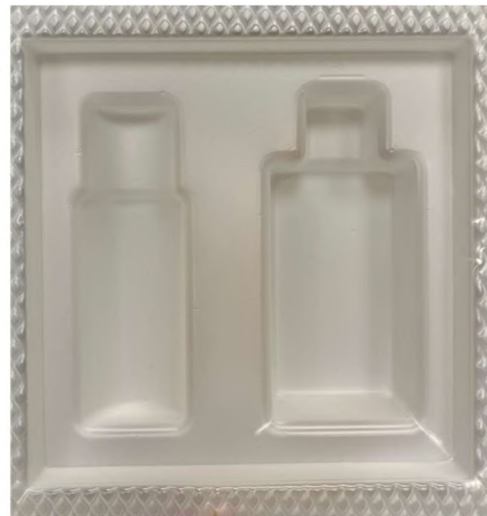
Ilustración 116: Ensayo termoformado - molde macho mecanizado - PS 0.50 mm (Elaboración propia)
