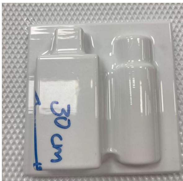
Ilustración 28: Ensayo macho sin vacío - HIPS 1mm (Elaboración propia)
