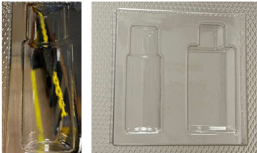
Ilustración 109: Ensayo termoformado - molde hembra impreso en 3D - PETG 1.00 mm (Elaboración propia)
