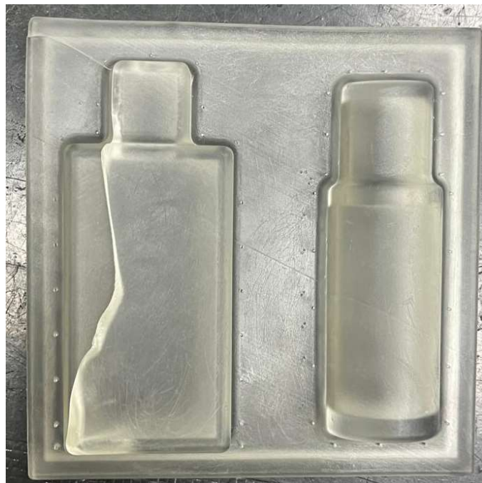
Ilustración 123: Fractura del molde macho Clear V4 (Elaboración propia)
