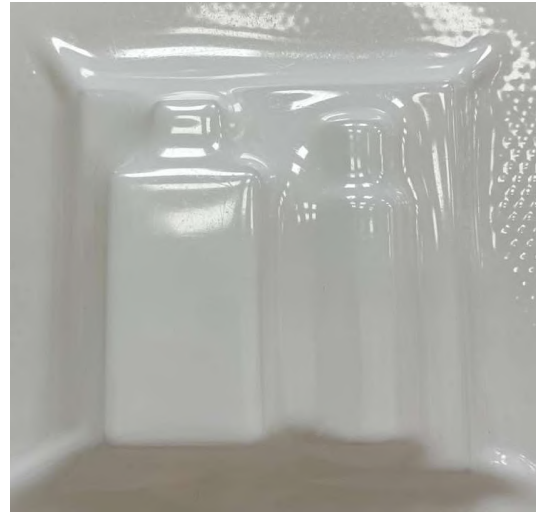
Ilustración 33: Ensayo macho sin vacío - PC 0.7mm (Elaboración propia)
