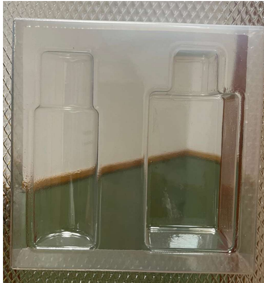
Ilustración 108: Ensayo termoformado - molde hembra impreso en 3D - PETG 0.7 mm (Elaboración propia)
