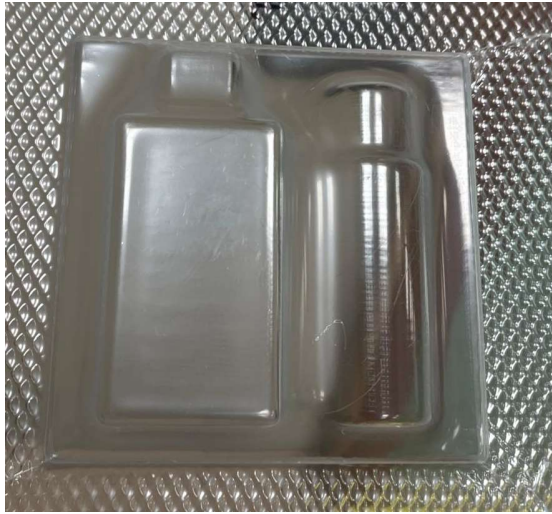
Ilustración 32: Ensayo macho sin vacío - PS 1mm (Elaboración propia)
