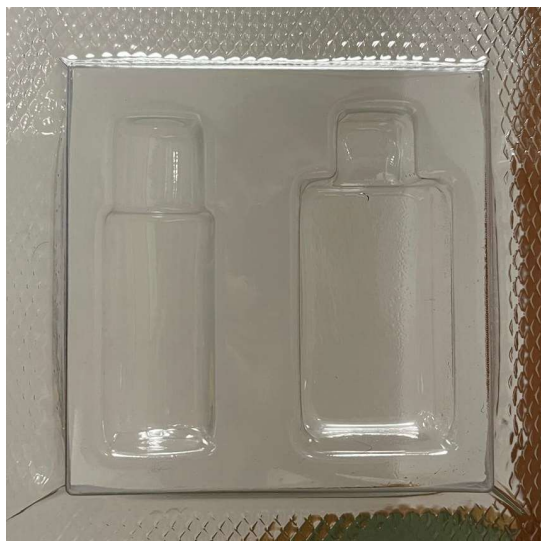
Ilustración 112: Ensayo termoformado - molde hembra impreso en 3D 0.7 mm (Elaboración propia)
