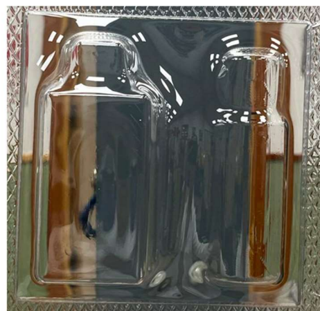
Ilustración 91: Prueba de termoformado del molde macho en Aluminio sin agujeros de vacío (Elaboración propia)
