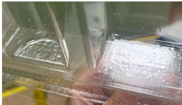
Ilustración 51: Resultado del lijado de los moldes hembra (Elaboración propia)
