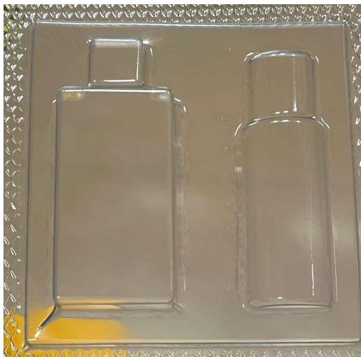
Ilustración 99: Ensayo termoformado - molde macho en 3D - PVC 0.7 mm (Elaboración propia)
