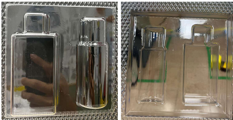
Ilustración 114: Ensayo termoformado - molde macho mecanizado - PETG 0.70 mm (Elaboración propia)
