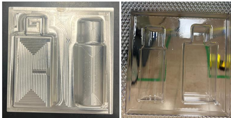
Ilustración 10: Molde fabricado por MCNC (izquierda) y blíster obtenido mediante termoformado (derecha) (Elaboración propia)
