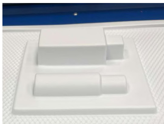
Ilustración 67: Prueba inicial molde macho V2 - PS 1mm (blanco) (Elaboración propia)
