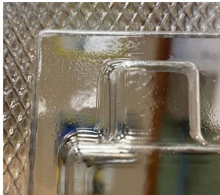
Ilustración 92: Efecto del chorreado en el blíster (Elaboración propia)
