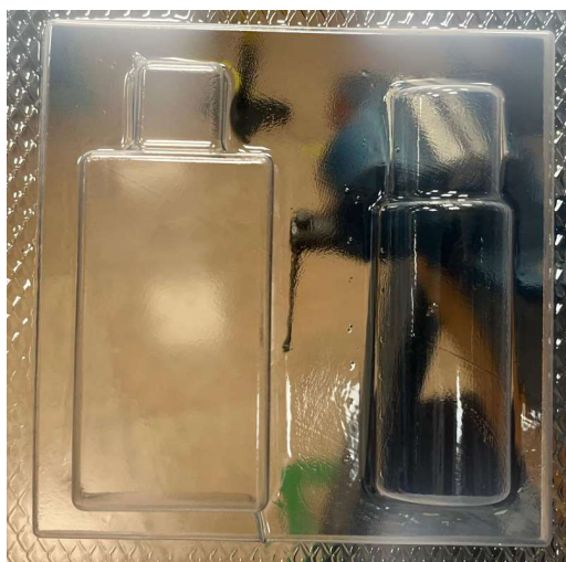
Ilustración 102: Ensayos del modelo macho con sistema de varillas de guiado – PETG 0.7 mm (Elaboración propia)
