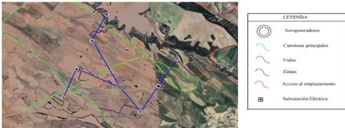
Figura 88. Zanjas del proyecto
