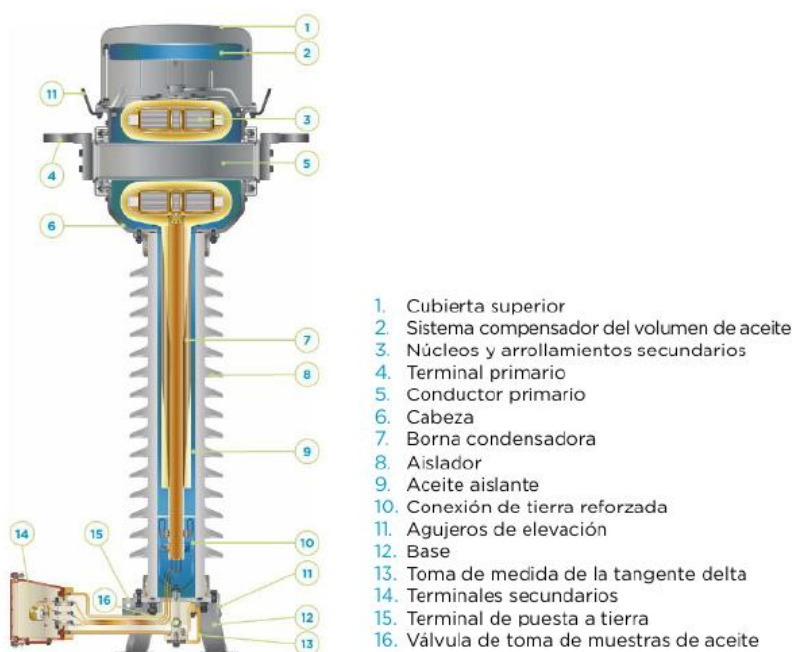
Figura 80. Esquema del transformador de intensidad del fabricante Arteche seleccionado
