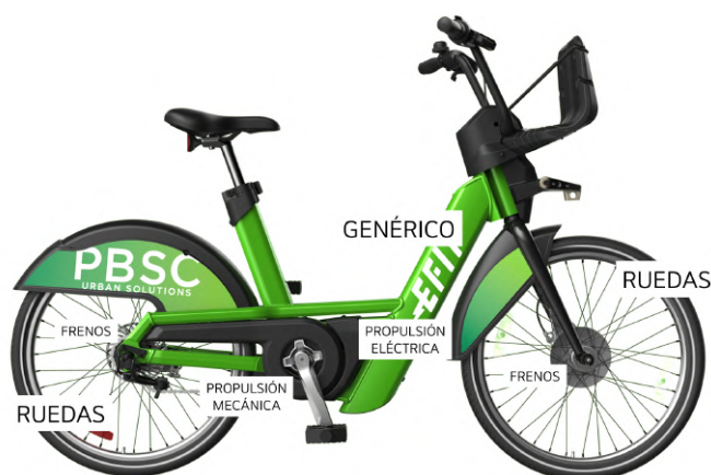
Figura 5.10: Esquema de las partes de la bicicleta [Elaboración propia]
