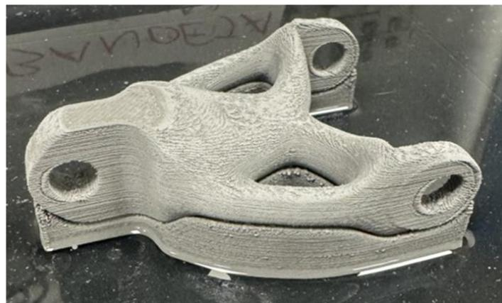
*Figura 52. Diseño CAD pieza con base de apoyo junto a su resultado final.*
