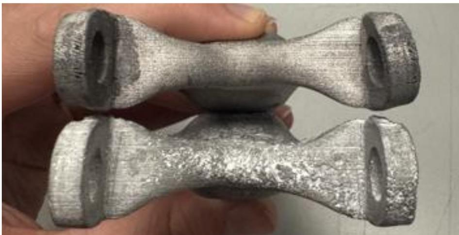
*Figura 68. Comparativa modelo por FDM Metal (parte superior) con modelo por fundición*
