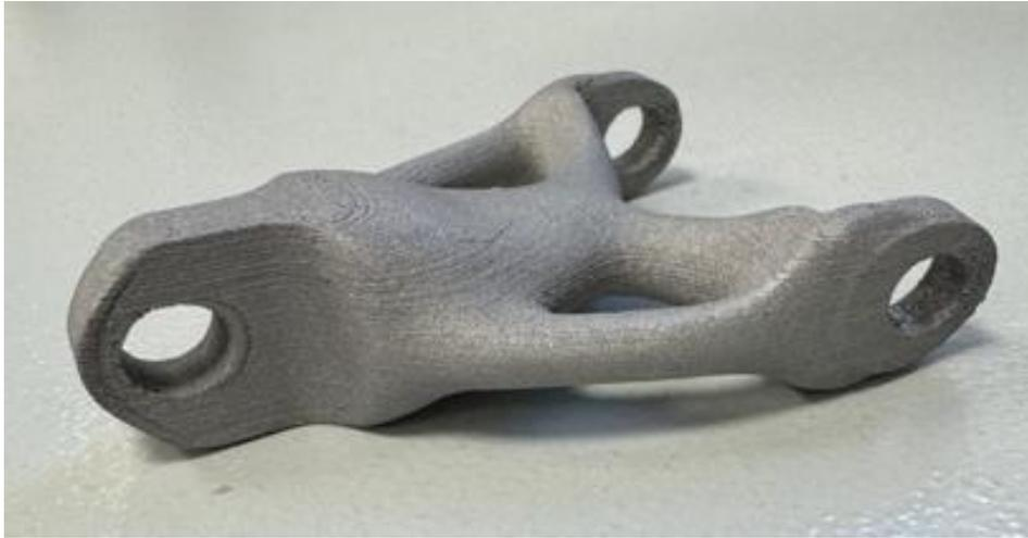
*Figura 67. Modelo experimento soporte sinterizado y limpiado*
