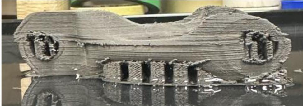
*Figura 41. Error de calibración a media impresión*
