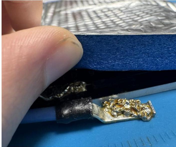
*Figura 40. Cable de alimentación de cama caliente. Despegado y con mala soldadura*
