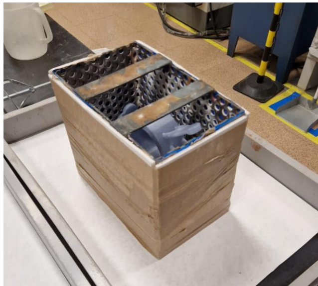
Ilustración 67: Preparación del molde cerámico con la jaula y el modelo impreso en 3D (Fuente: Elaboración propia)
