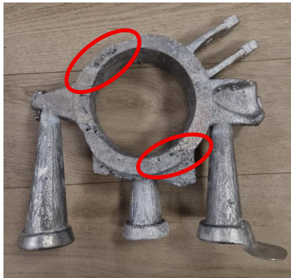
Ilustración 74: Porosidades externas en el anillo de la mangueta (Fuente: Elaboración propia)
