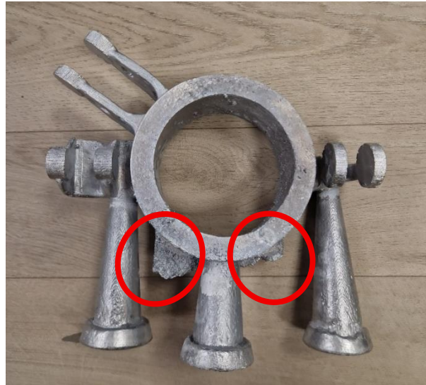
Ilustración 75: Llenado incompleto en la zona de anclaje de las pinzas de freno (Fuente: Elaboración propia)
