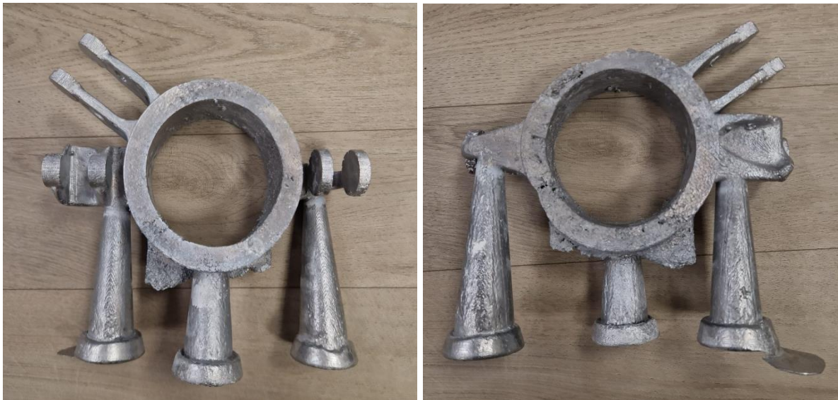
Ilustración 3: Resultados de la mangueta final obtenida tras la fundición al modelo perdido (Fuente: Elaboración propia)
