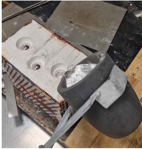
Ilustración 72: Momento de la colada del metal (Fuente: Elaboración propia)
