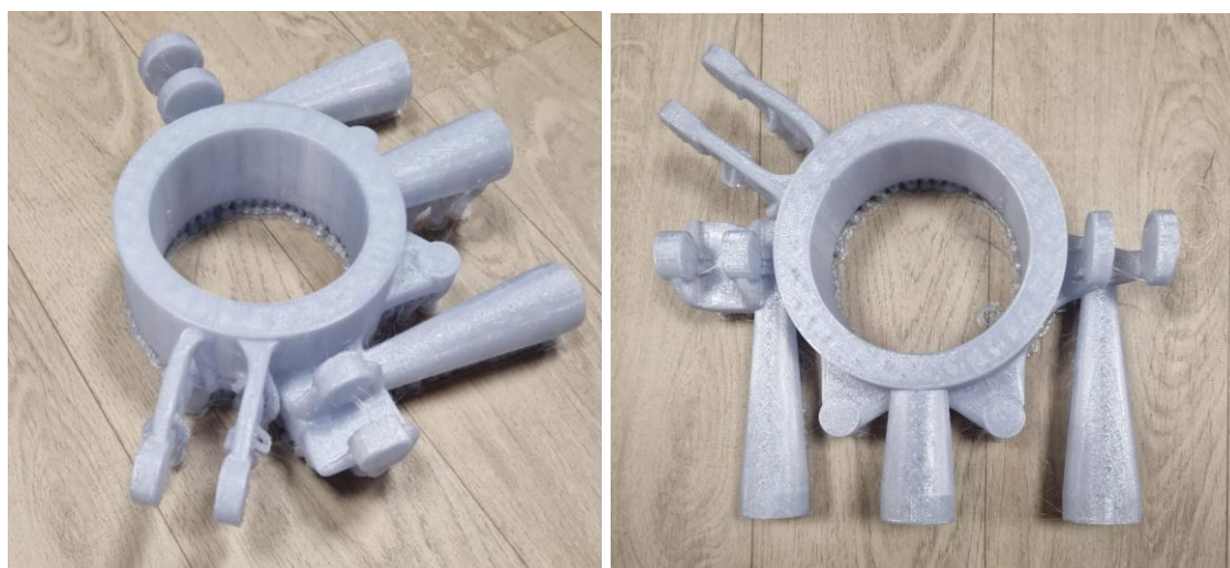
Ilustración 61: Resultado primera impresión Flashforge Adventurer 5M Pro (Fuente: Elaboración propia)
