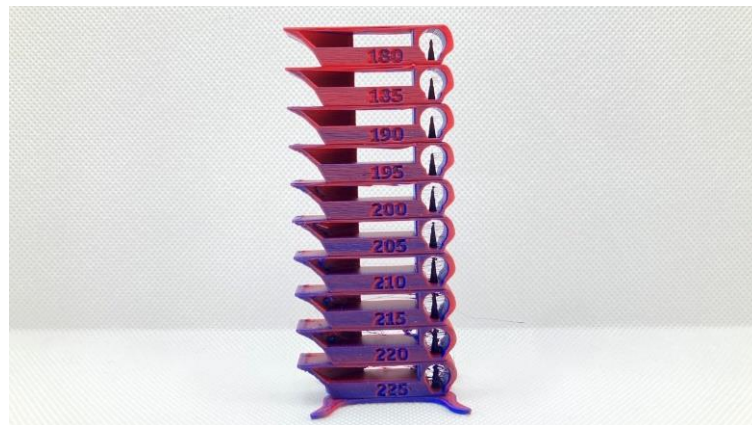
Ilustración 23: Torre de temperaturas para deducir parámetros de impresión (Fuente: All3DP[19])
