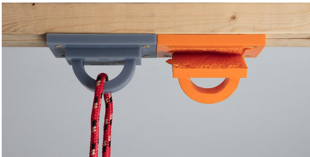
Ilustración 33: Comparativa de la fragilidad entre una pieza funcional impresa en SLA (gris) y otra en FDM (naranja) (Fuente: Formlabs [30])
