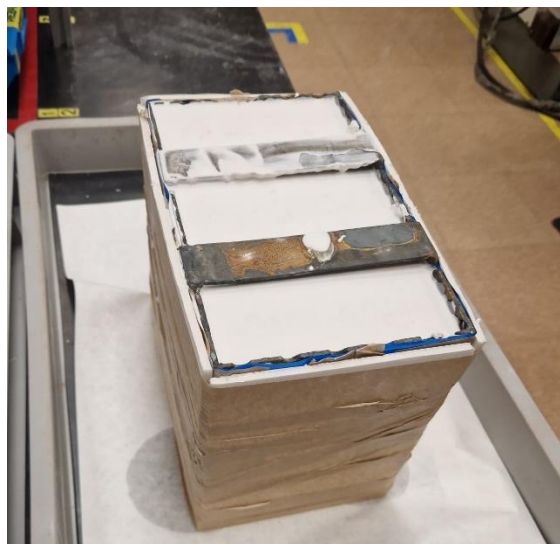
Ilustración 69: Molde cerámico con el revestimiento vertido sobre la jaula (Fuente: Elaboración propia)
