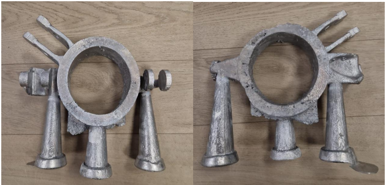
Ilustración 73: Resultado final de la fundición de la mangueta por la técnica de modelo 3D perdido (Fuente: Elaboración propia)
