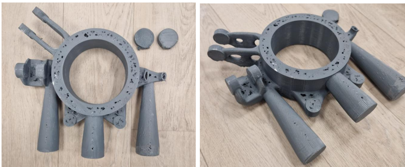
Ilustración 59: Primera impresión DT600 con malos resultados (Fuente: Elaboración propia)
