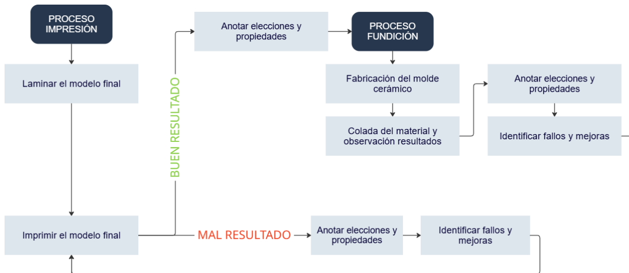
Ilustración 2: Flujo de trabajo del entorno de impresión 3D del modelo y fundición en el proyecto (Fuente: Elaboración propia)
