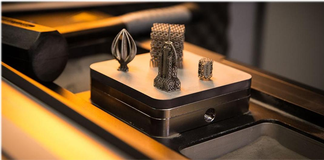
*Ilustración 32: Piezas fabricadas mediante DMLS (fuente protolabs)*
