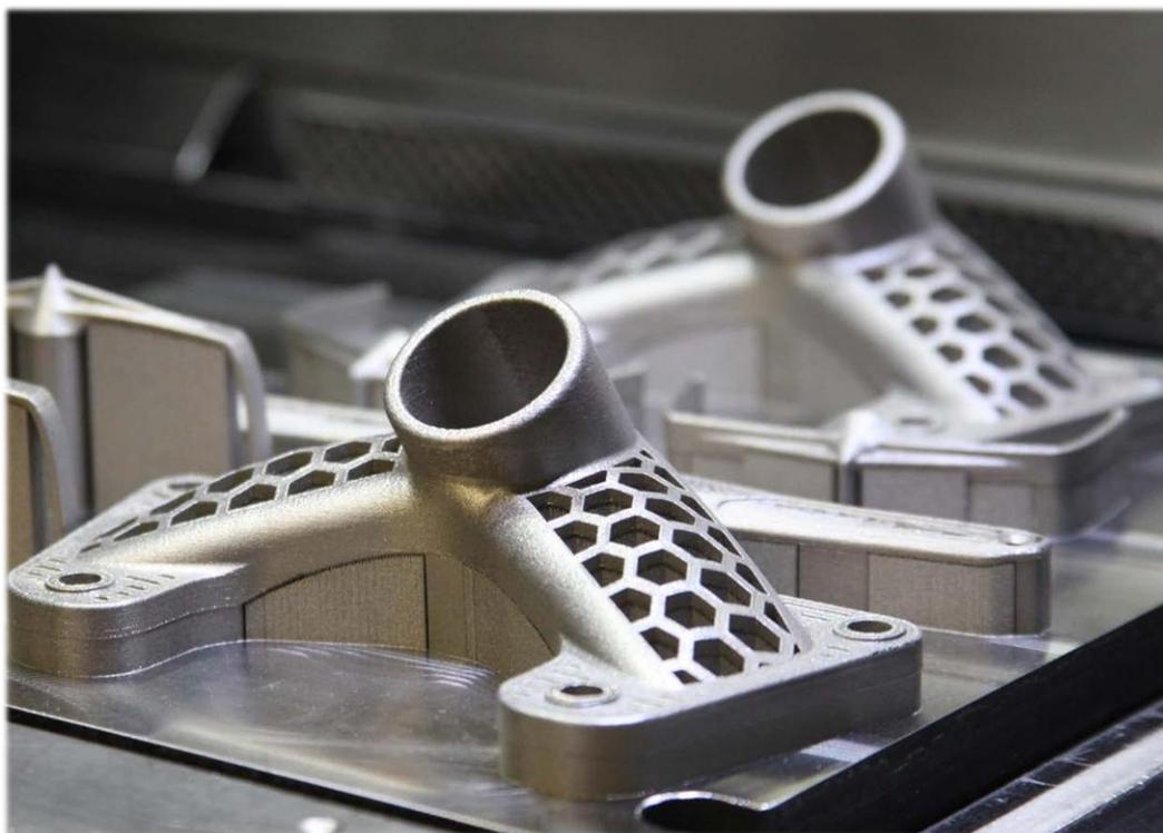
*Ilustración 20: DMLS (fuente KDMfabrication)*
