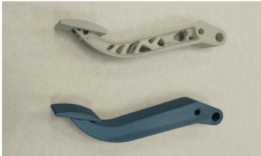
*Ilustración 3: Prototipos fabricados mediante I3D (fuente: elaboración propia)*
