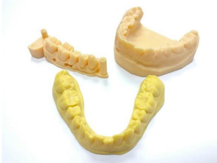
*Ilustración 23: Dentaduras impresas mediante SLA (fuente: TRD)*
