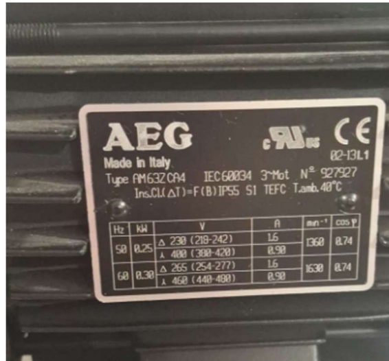
Figura 40 Placa de Características del Motor
