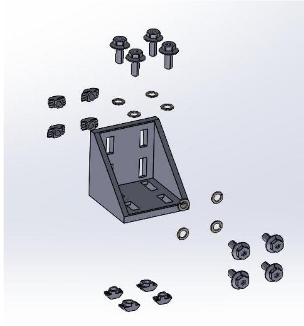
*Figura 19: Esquema de montaje de las escuadras*
