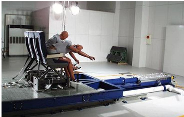
*Figura 2: Trineo invertido [7]*
