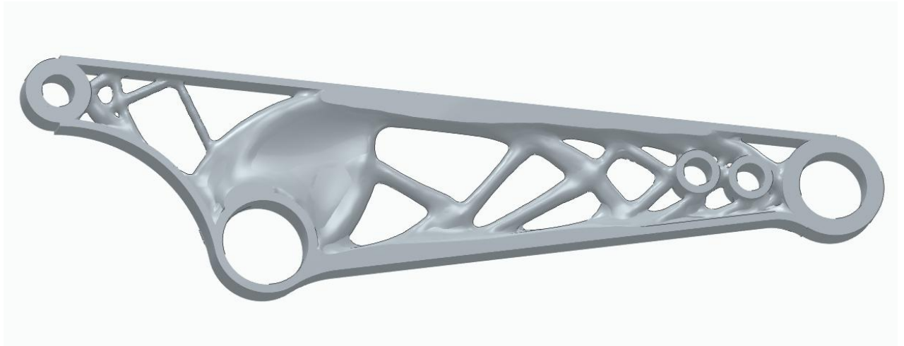
Figura 47 Optimización topológica restringida, fuente propia
