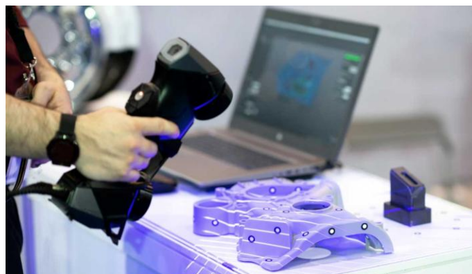
Figura 7 Escaneado 3D mediante escáner de luz blanca [12]
