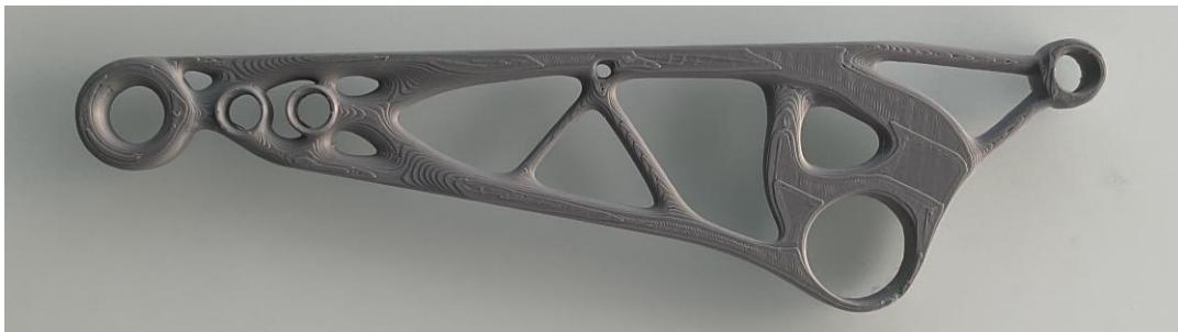
Figura 60 Prototipo de la bieleta con optimización libre impreso (FDM), fuente propia
