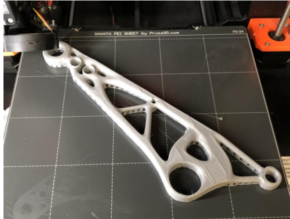
Figura 2 Impresora 3D imprimiendo el prototipo optimizado, fuente propia
