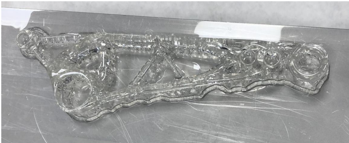
Figura 57 Bieleta de optimización libre tras sacarla de la impresora de resina, fuente propia
