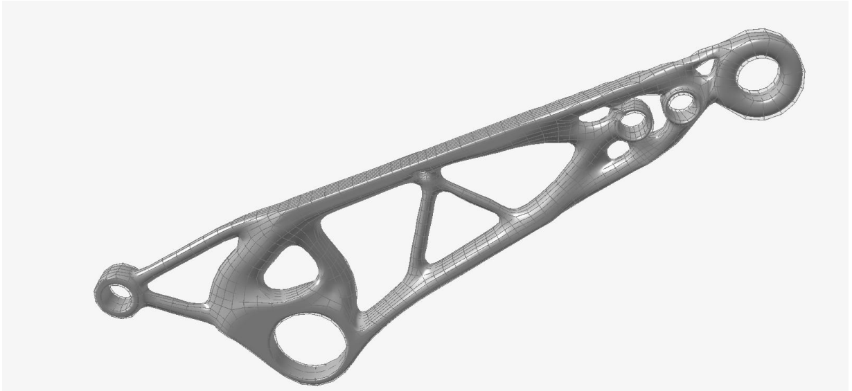
Figura 49 Bieleta refinada (optimización libre), fuente propia
