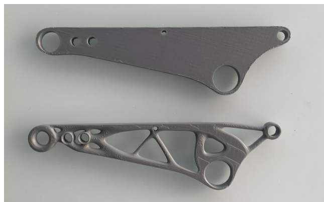
Figura 3 Comparativa entre el prototipo original y el escaneado, fuente propia
