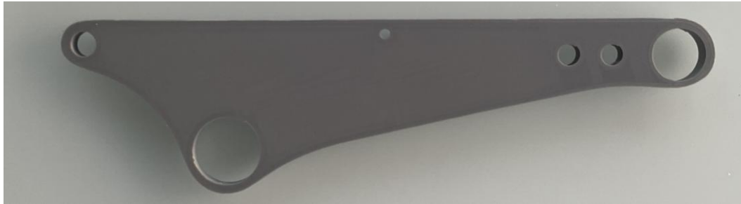
Figura 59 Prototipo de la bieleta original impreso (FDM), fuente propia
