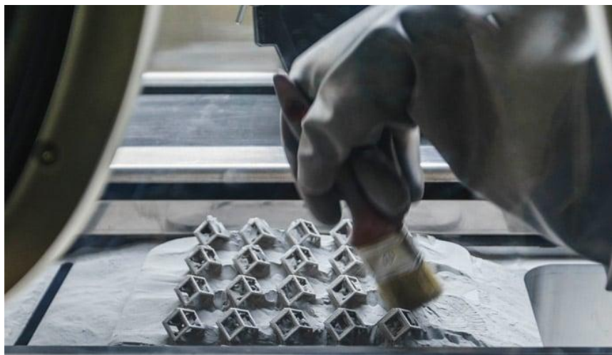
Figura 13 Proceso de postprocesado en fabricación aditiva por fusión de lecho de polvo[22]
