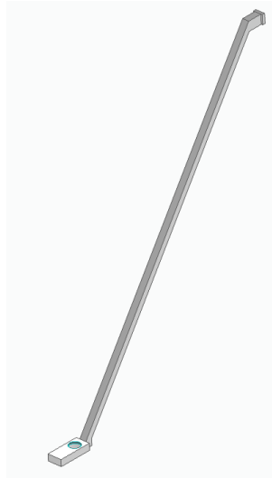
Figura 15: Refuerzo lateral para la estabilidad.
