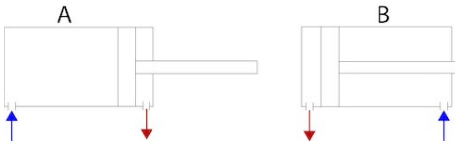
Figura 59: Funcionamiento pistón de doble efecto.
