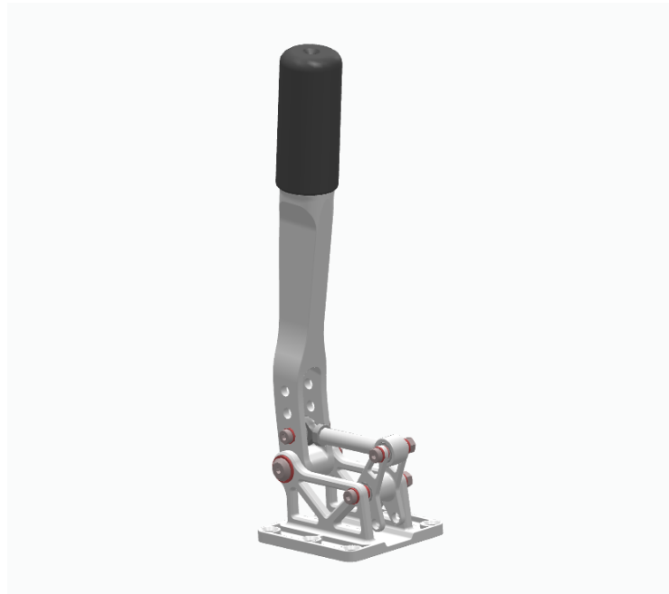
Figura 26: Ensamble del mecanismo de la Palanca Secuencial.
