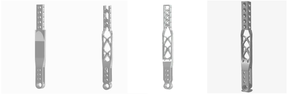
Figura 4: Optimización mediante Diseño generativo y refinado.
