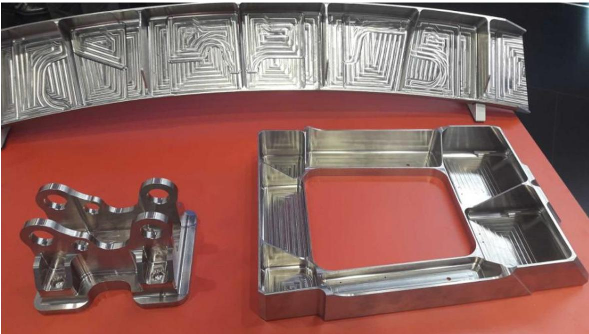
Ilustración 22. Componentes impresos por el método Láser Cladding (Fuente: *Impresión 3D de Componentes Metálicos Mediante Láser Cladding En Hilo*, s. f.) [14]
