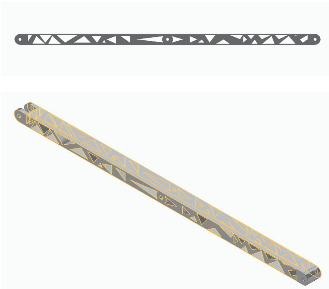
Ilustración 62. Barra con la propuesta 1 de la optimización de forma
