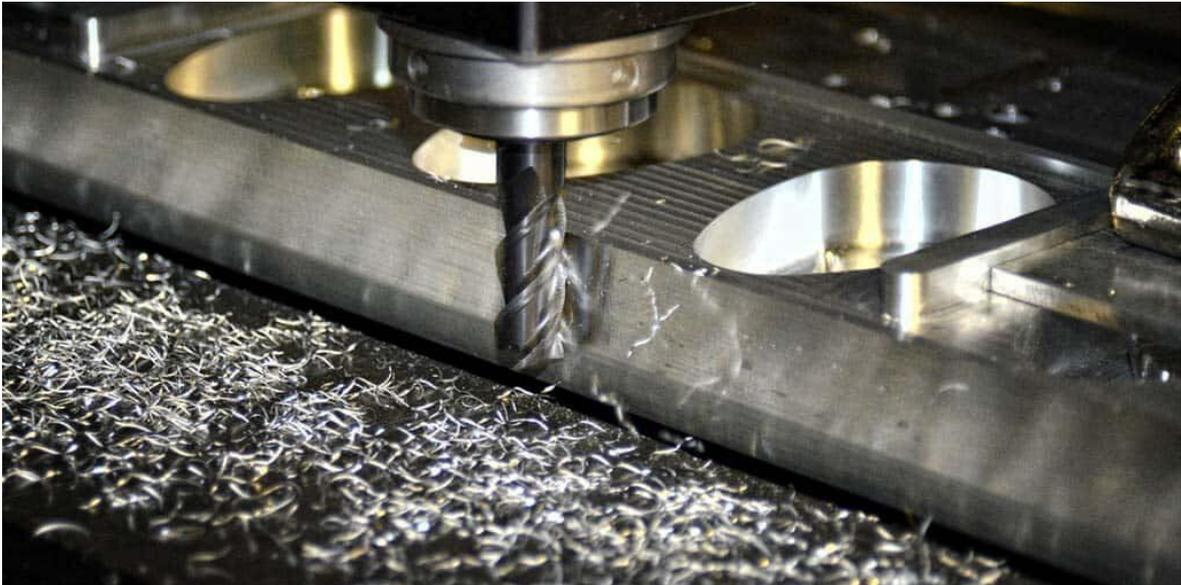
Ilustración 29. Pieza siendo mecanizada por una fresadora (Fuente: Aceromafe, 2025) [23]
