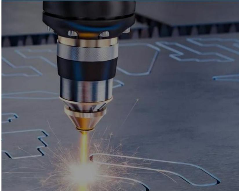
Ilustración 27. Plancha cortada por Láser (Fuente: *Corte Por Láser - Dassault Systèmes*, 2023) [20]
