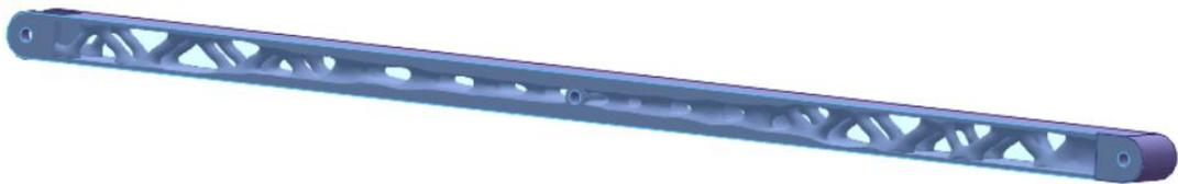
Ilustración 53. Barra con una reducción de masa del 40%
