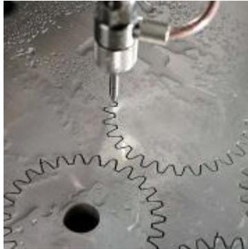
Ilustración 23. Ejemplo de corte por chorro de agua (Manufactures Cusell, 2022) [17]
