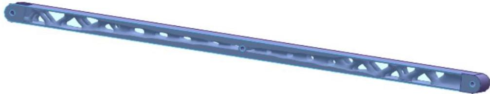
Ilustración 51. Barra con una reducción de masa del 35%
