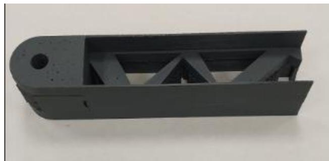
Ilustración 74. Prototipo, optimizado en forma, impreso
