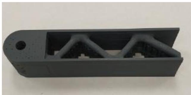
Ilustración 72. Prototipo, optimizado topológicamente, impreso
