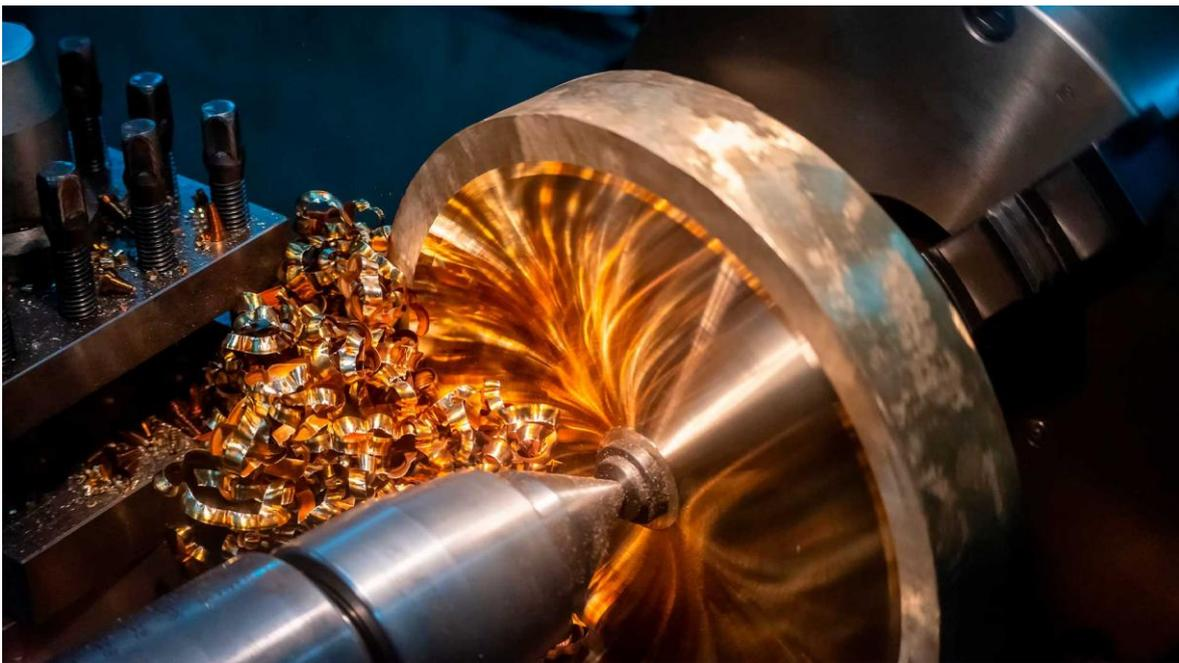
Ilustración 30. Pieza siendo mecanizada por un torno (Fuente: Umesal, 2024) [24]
