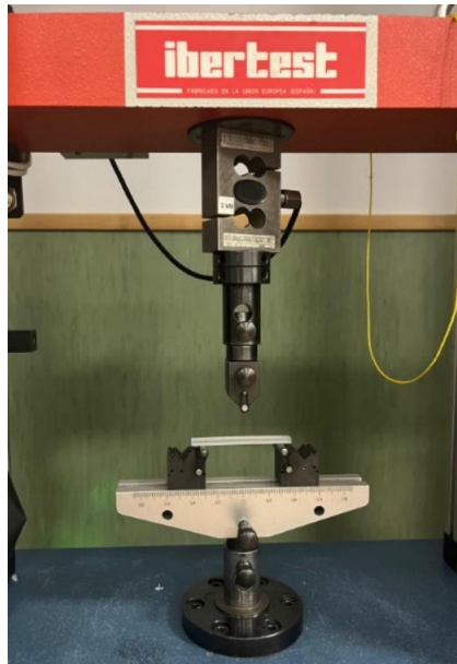
Imagen 21. Ensayo de flexión a 3 puntos ELIB 20
