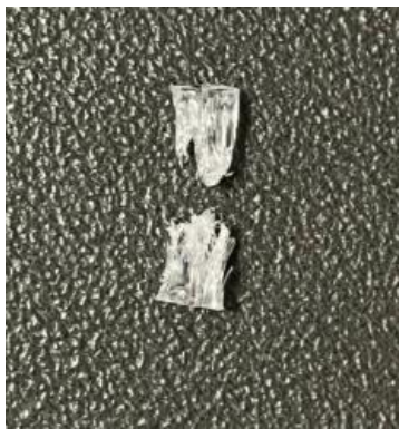
Imagen 30. Rotura frágil explosiva
