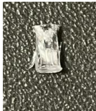
Imagen 31. Fallo por microfisuración interna
