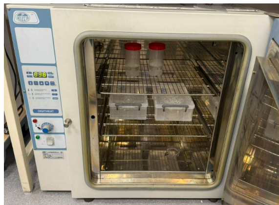
Imagen 18. Muestras en la estufa para su envejecimiento
