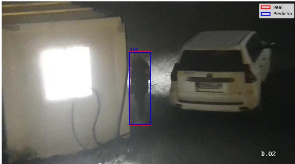
Ilustración 22. Inferencia Faster R-CNN preentrenado 1 (elaboración propia)
