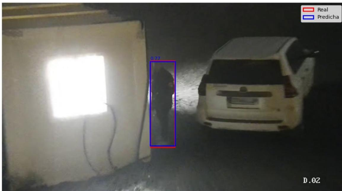
*Ilustración 31. Inferencia YOLOv8m preentrenado 1 (elaboración propia)*
