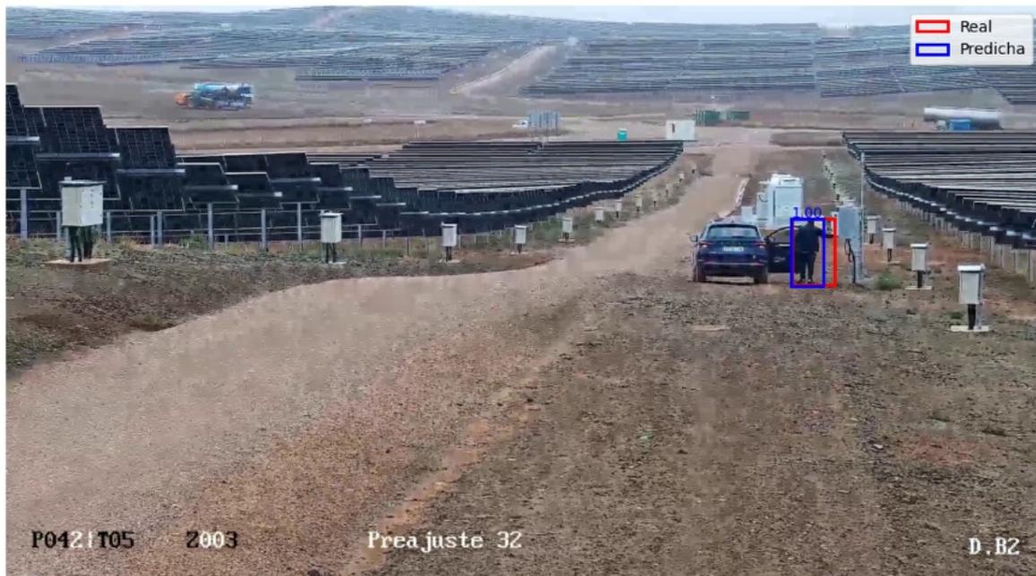
Ilustración 23. Inferencia Faster R-CNN preentrenado 2 (elaboración propia)
