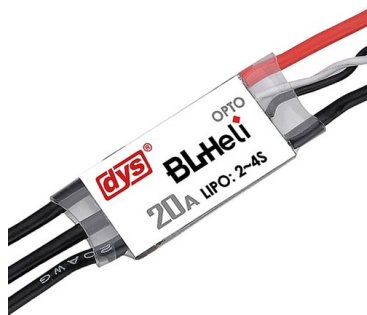
Figura 1.6: ESC BLHeli 20A (Fuente: Oscar Liang)
