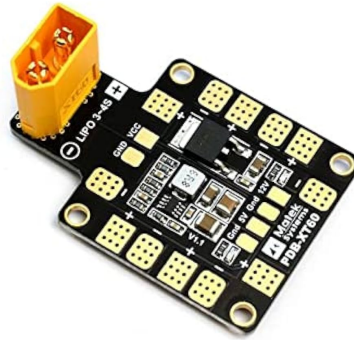
Figura 1.7: PDB con conector XT60 (Fuente: Amazon)
