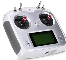
Figura 1.8: Emisora FS-i6S (Fuente: RC Innovations)
