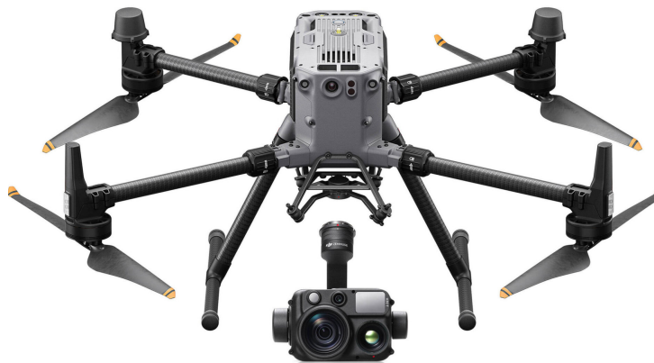
Figura 2.6: Dron multirrotor con cámara térmica y óptica, empleado en aplicaciones de vigilancia y búsqueda
