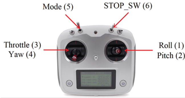
Figura 5.11: Distribución de canales de la emisora
