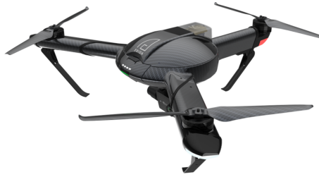
Figura 3.2: Ejemplo de dron con configuración tricóptero (Fuente: Xataca)
