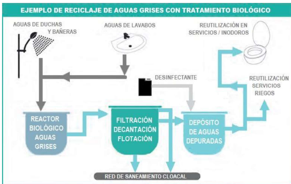
Ilustración 24: Esquema de tratamiento biológico de aguas grises. Fuente: Metertech (42)
