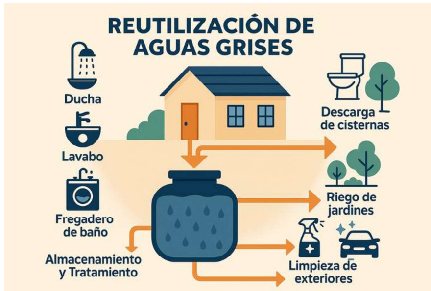
Ilustración 23: Esquema de reutilización de aguas grises en edificios residenciales. Fuente: Ruberte (40)
