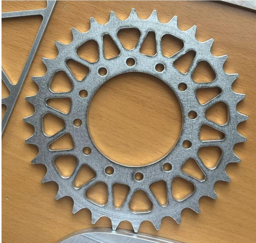
*Ilustración 37. Resultado final de fabricación de la corona*
