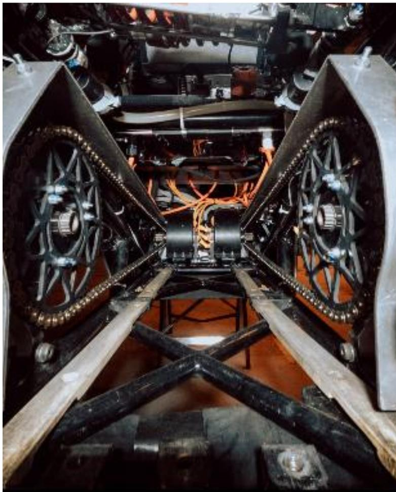
*Ilustración 18. Sistema de transmisión de FaSSTUBe*
