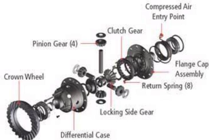
*Ilustración 12. Diferencial de deslizamiento limitado*
