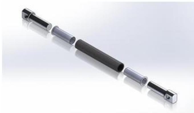
*Ilustración 41. Vista explosionada del ensamblaje de los tensores [9, p. 10]*
