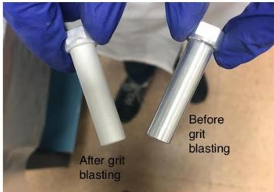
*Ilustración 60. Preparación superficial de los insertos [10, p. 79]*
