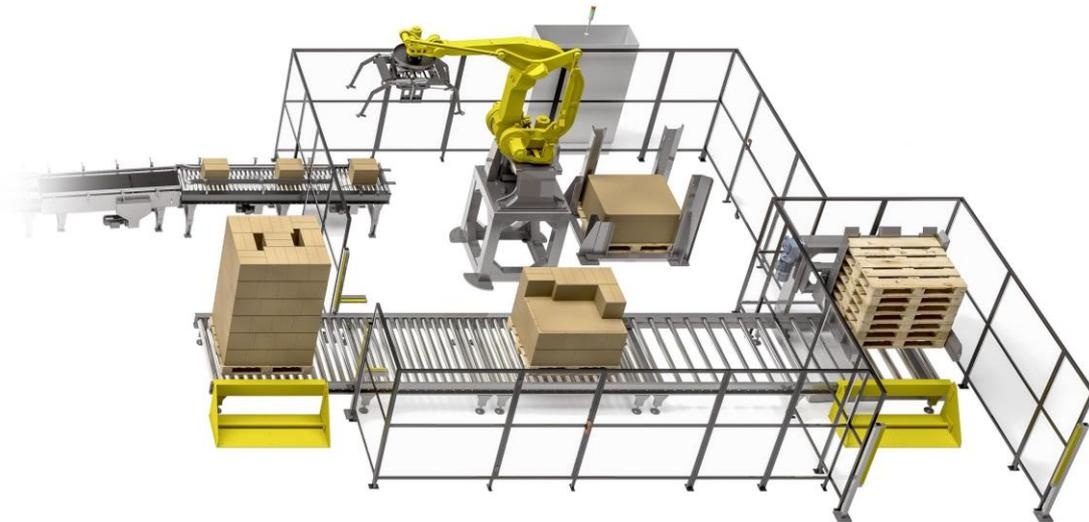
*Figura 4. Ejemplo de configuración de brazo robot en estación palletizadora (TMG Impianti, 2025)*
