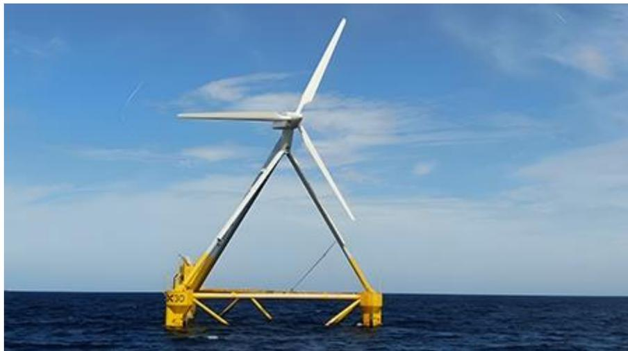
*Ilustración 47: Aerogenerador con plataforma TLP*
