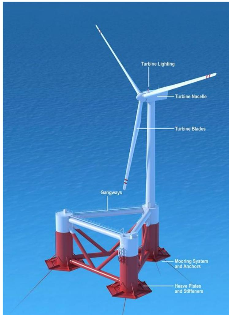
*Ilustración 45: Plataforma tipo semisumergible*
