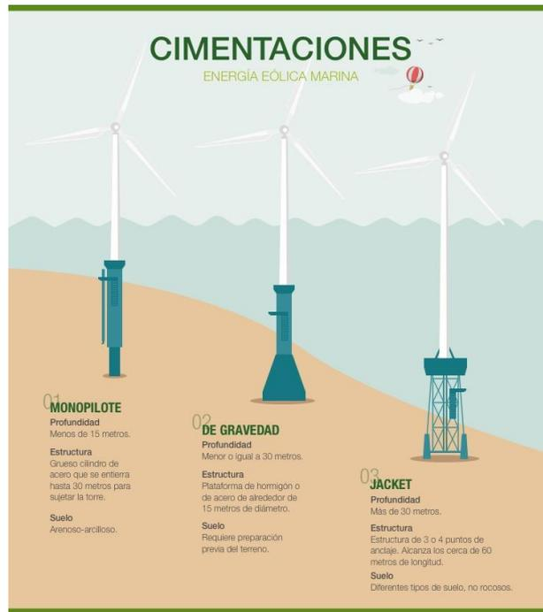
*Ilustración 2: Tipos de aerogenerador marinos con cimentación fija*
