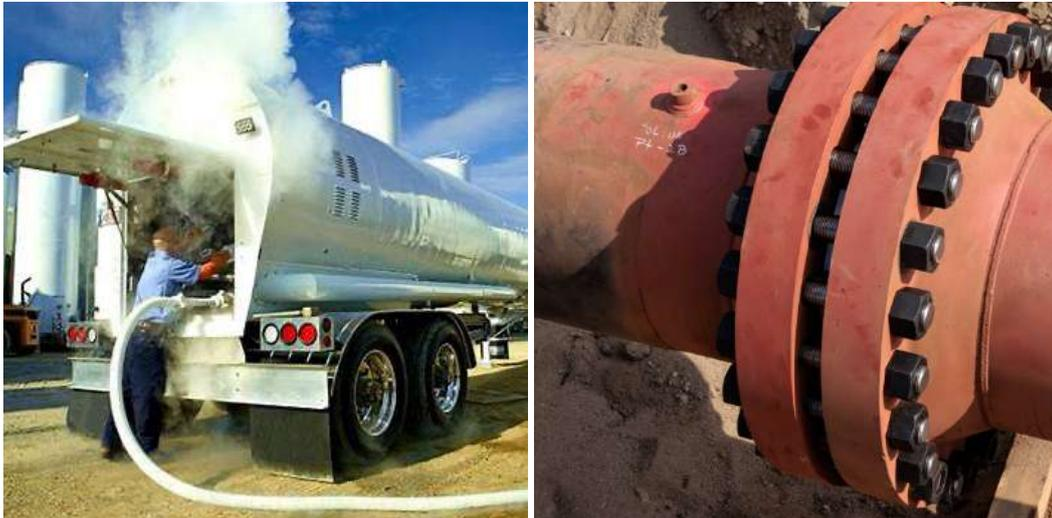
*Figura 20: Camión cisterna de CO<sub>2</sub> descargando mediante manguera de inoxidable.*
