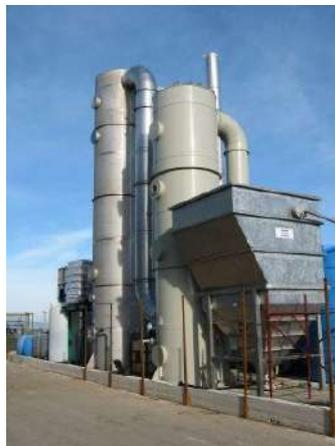
Figura 8: Columna de desorción. Fuente: DirectIndustry.
