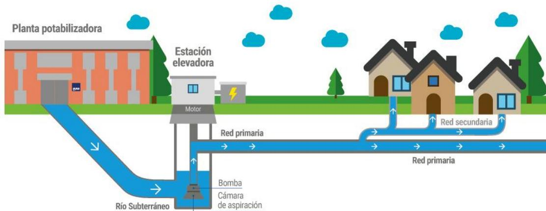
*Ilustración 11: Sistema de distribución de agua potable. Fuente: AySA – Sistema de distribución de agua potable. Aysa.com.ar (2020)*
