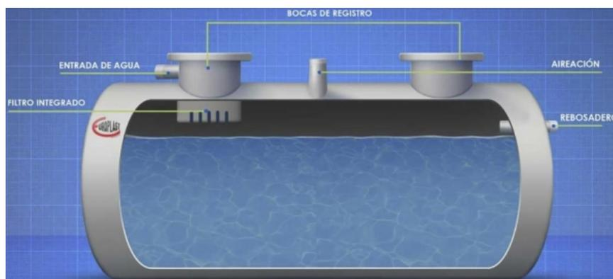
*Ilustración 18: Tanque para la acumulación de agua pluviales. Fuente: Europlast (s.f)*
