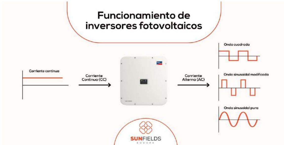
*Ilustración 23: Funcionamiento de inversor (Fuente: Sundfields Europe)*
