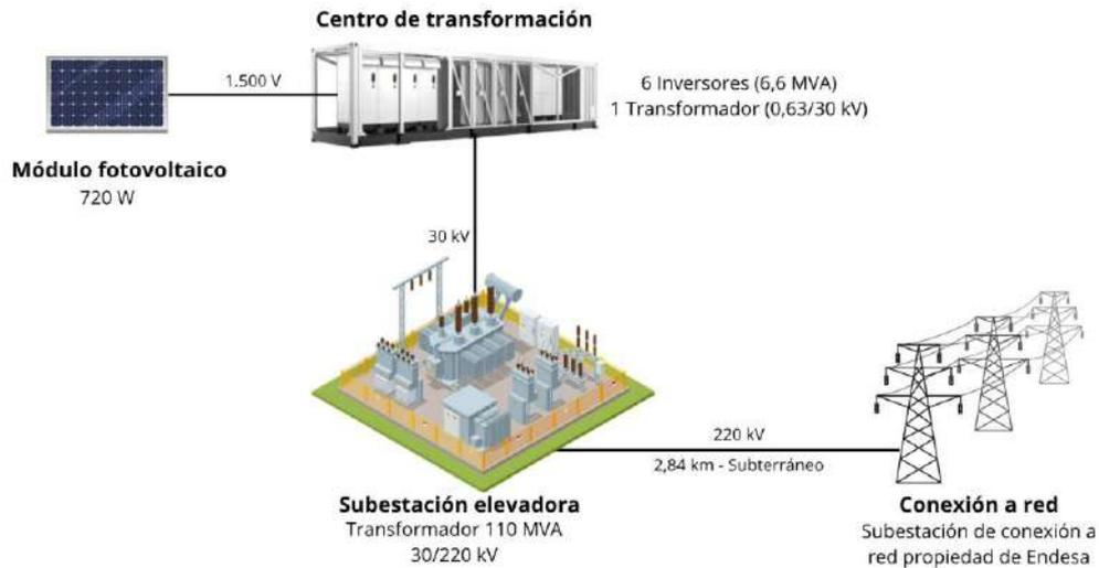
*Ilustración 1: Esquema de la planta fotovoltaica (Fuente: Elaboración Propia)*
