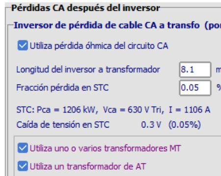
Ilustración 63: Parametrización de las pérdidas cable CA al transformador (Fuente: PVSyst®)
