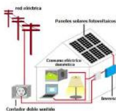
*Ilustración 26: Conexión mediante inversor [15]*
