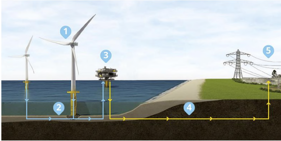
Figura 6.1: Cableado de un parque eólico [2]
