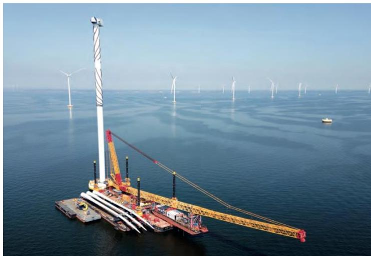
*Ilustración 14: Buque especializado transportando aerogeneradores.*
