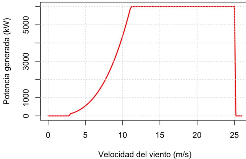
Ilustración 28: Gráfico de la curva de potencia aproximado de la turbina GE Haliade 150-6MW. Fuente: Elaboración propia
