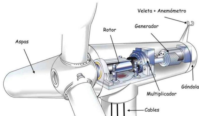
*Ilustración 26: Diseño de un aerogenerador*
