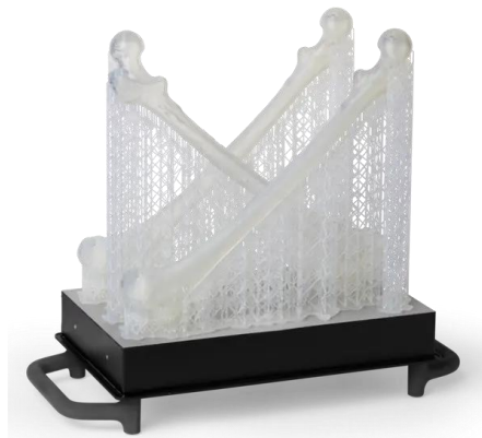
Figura 7 Pieza impresa en 3D con resina Clear V4 utilizando tecnología SLA
