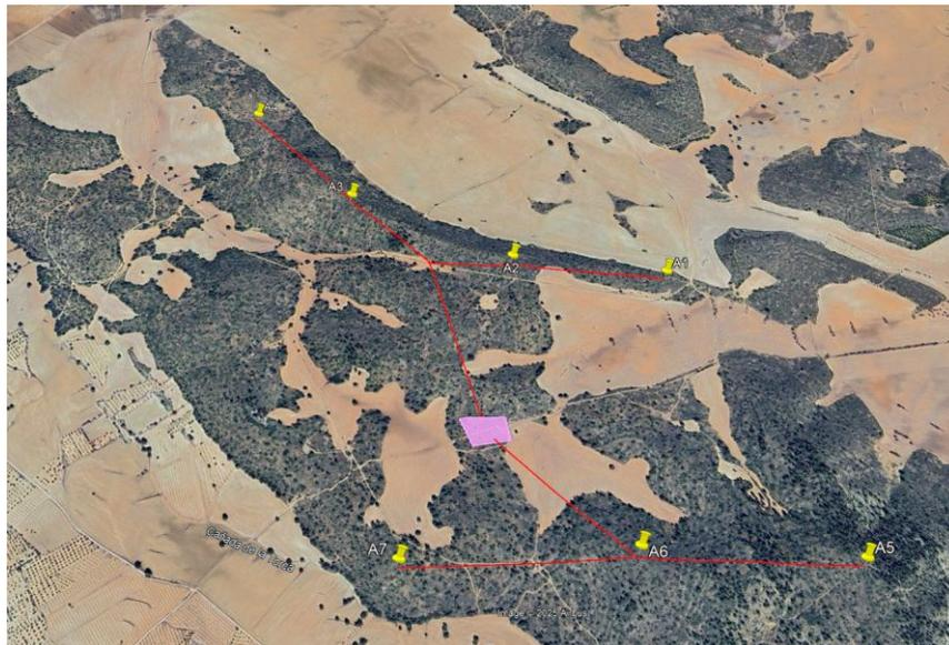
*Ilustración 13. Trazado de las zanjas eléctricas desde los aerogeneradores a la subestación.*
