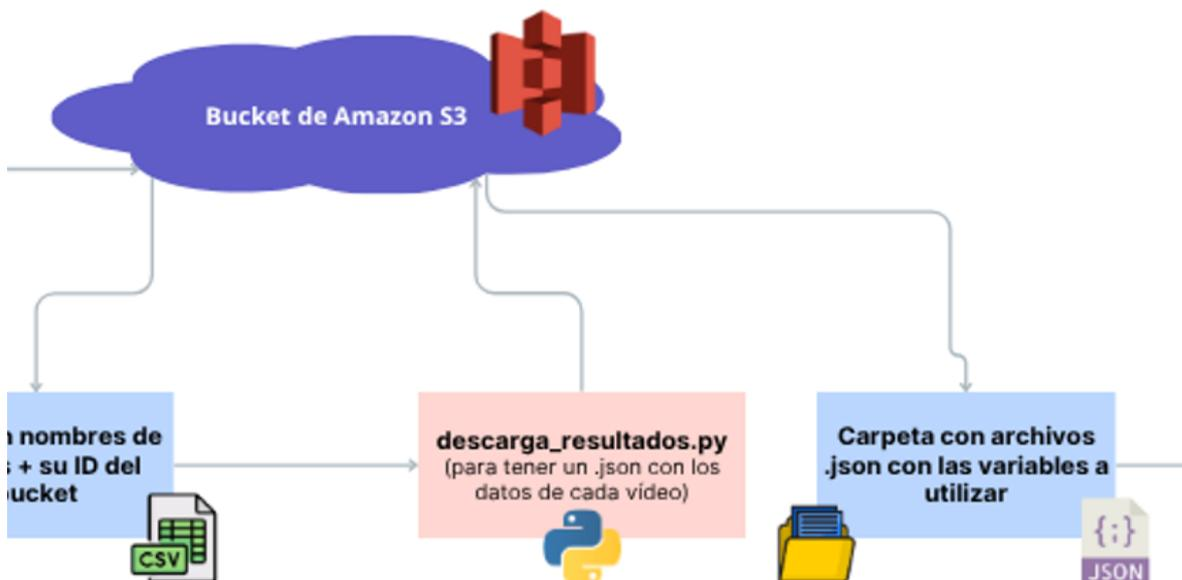
*Figura 12 - Parte del diagrama de bloques que ilustra el proceso de descarga de los resultados obtenidos por el bucket S3*
