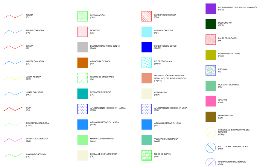
Figura 4. Leyenda de patologías.
