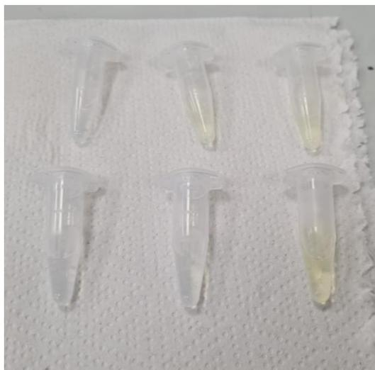
*Figura 42: Comparación de colores del medio Tris-HCl(arriba) y PBS (abajo) únicamente con concentración-0.4 de pNP-B (medio), ante la adición de HCl (izquierda) y NaOH (derecha)*
