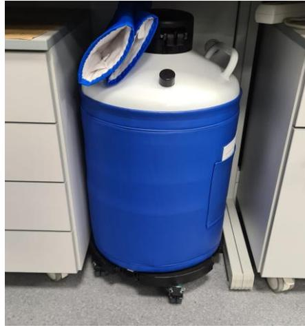
*Figura 7: Depósito de nitrógeno líquido y guantes de protección*
