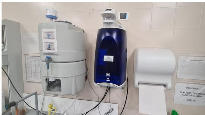
*Figura 10: Purificador de agua Direct-Q 5UV*
