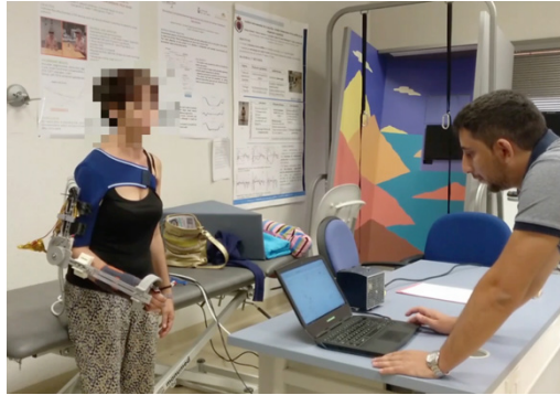
Figura 6. Exoesqueleto de codo desarrollado por el RoboticsLab de la Universidad Carlos III de Madrid para la rehabilitación de personas que han sufrido ictus
