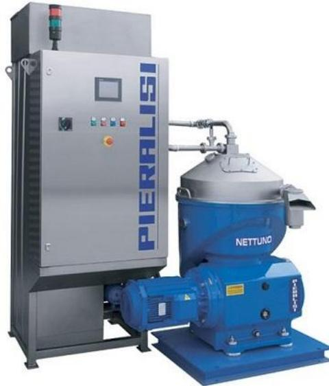
Figura 18. Centrifugadora vertical de una almazara. Fuente: Pieralisi. [21]
