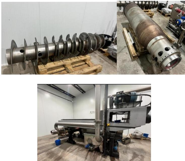
*Figura 17. Decanter bifásico desmontado para limpieza. 2025 (Elaboración propia almazara).*
