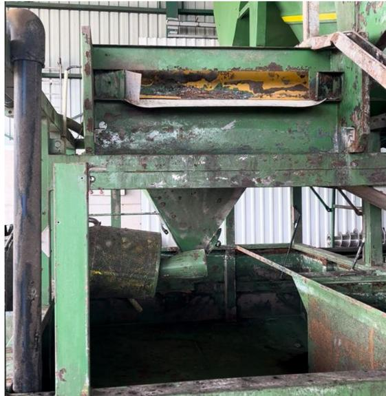
*Figura 12. Lavadora hidráulica. 2025 (Elaboración propia).*
