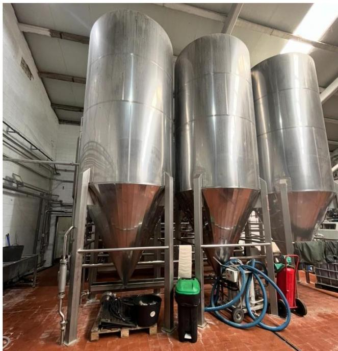
*Figura 19. Depósitos almacenamiento AOVE. 2025 (Elaboración propia).*
