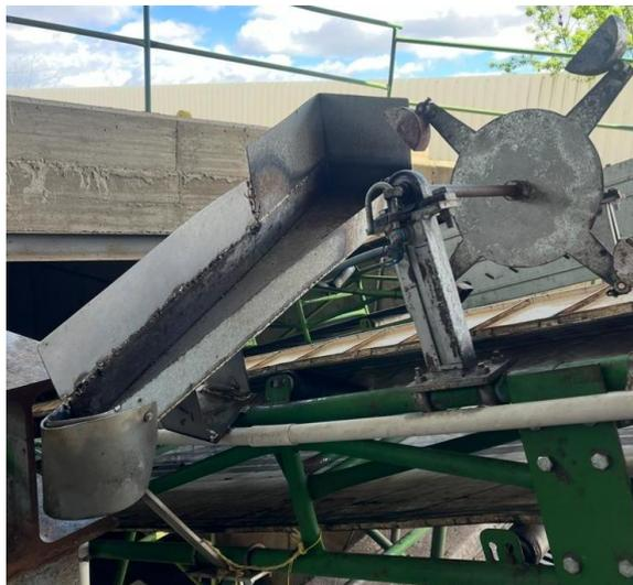
*Figura 13. Mecanismo para recogida de muestras. 2025 (Elaboración propia).*
