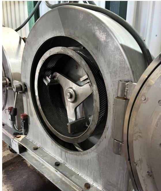
Figura 15. Interior molino de martillos. 2025 (Elaboración propia).
