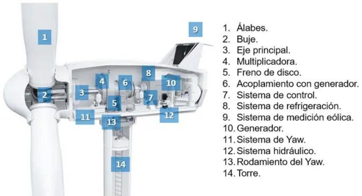
*Figura 31: Componentes de un aerogenerador eólico. (Muñoz, 2023)*
