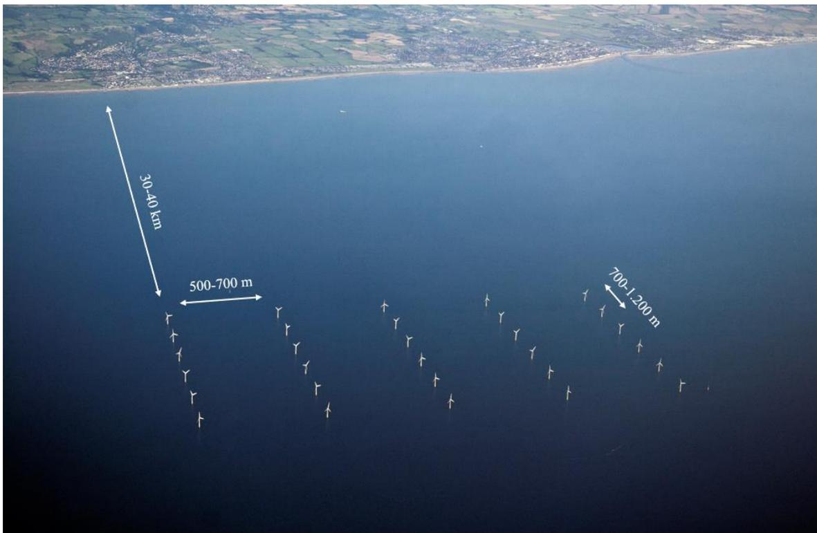
*Figura 29: Disposición típica de un parque eólico offshore. (Wikipedia, 2023)*
