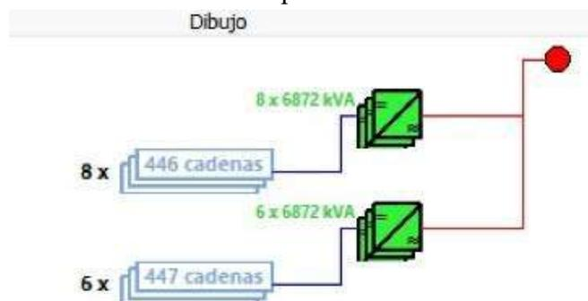
Figura 38. Representación unifilar de la simulación *PVSystem*
