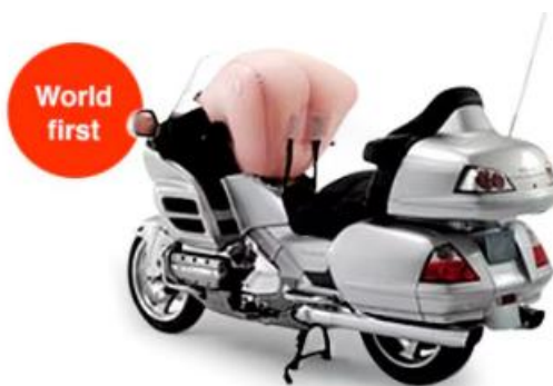
Ilustración 53: Honda Gold Wing con sistema de Airbag en motocicleta 81
