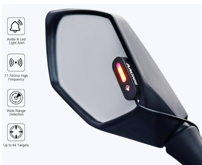
Ilustración 57: IINOVV sistema de detección ángulo muerto
