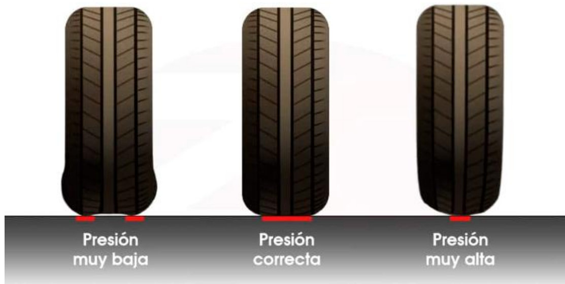
Ilustración 43: Diferencia de áreas según presión de neumáticos 49
