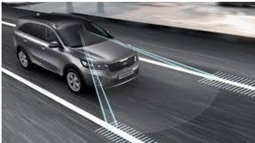
*Ilustración 16 Funcionamiento cámara (RACE)*
