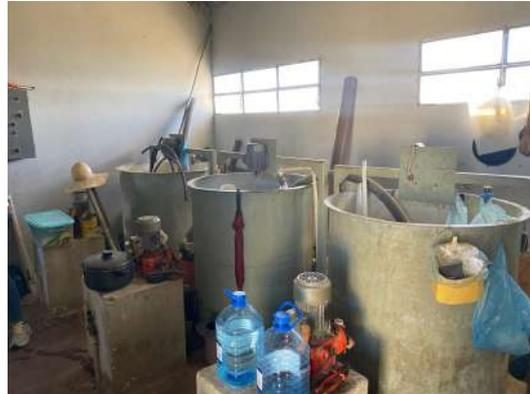
Figura 7.7: Mezcladoras con sus respectivos motores
