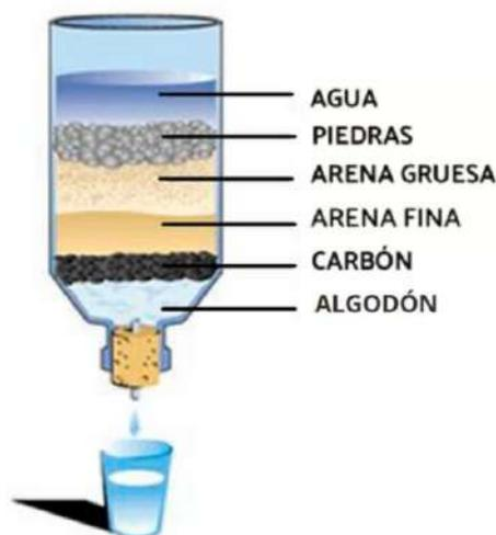
Figura 6.9: Sistema de filtración por gravedad
