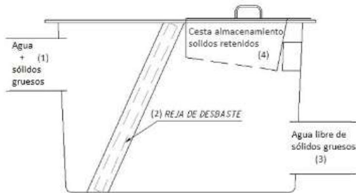
Figura 6.2: Funcionamiento desbaste del pretratamiento del agua
