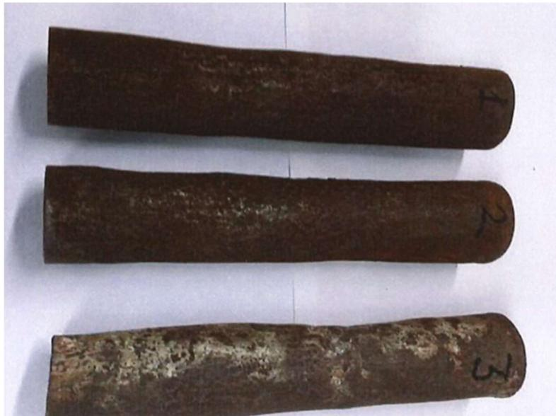
*Figura 13: Exterior de las muestras del sobrecalentador [13]*
