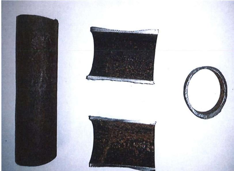
*Figura 14: Interior y borde de las muestras del sobrecalentador [13]*
