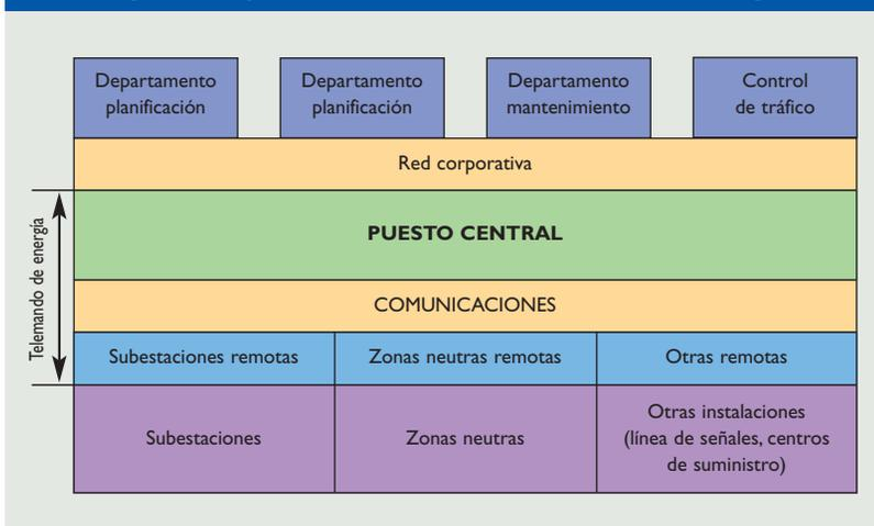
**Figura 3. Esquema simplificado del control distribuido de una subestación de tracción**
